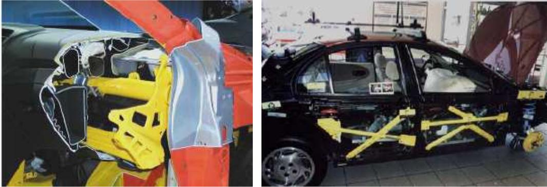
Figura 2-8. Refuerzo de acero microaleado en tablero y puertas (color amarillo).<sup>16</sup>
