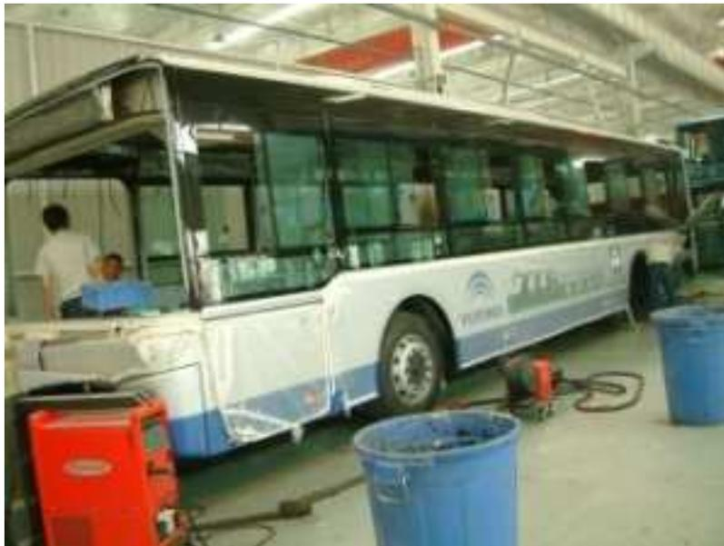
**Figura 2-13. Bus con carrocería de aluminio fabricado por Zhengzhou Yutong Bus Company<sup>24</sup>**
