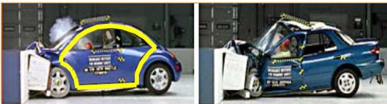
Figura 2-7. Comparación de cabinas luego de un impacto.<sup>16</sup>
