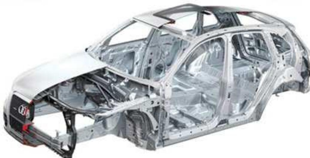
**Figura 2-12. Carrocería de aluminio. Audi Q5.<sup>22</sup>**
