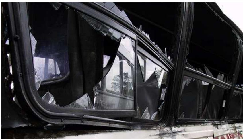
**Figura 1-5. Vidrios crudos luego de un accidente, usados en carrocerías de buses.<sup>9</sup>**
