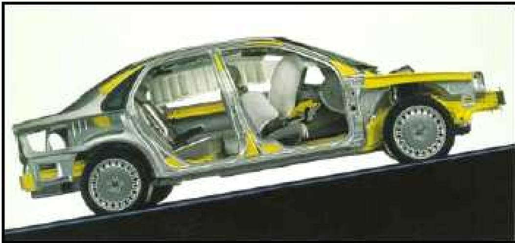
**Figura 2-5. Refuerzos de Acero HSLA (partes de color amarillo).<sup>16</sup>**
