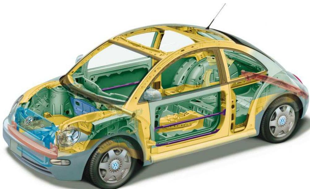
Figura 2-3. Carrocería con partes en amarillo de acero HSLA. Volkswagen Beetle.<sup>20</sup>
