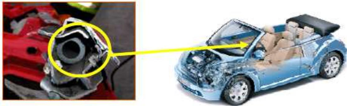
Figura 2-9. Refuerzo de acero microaleado en poste A del Volkswagen Beetle.<sup>16</sup>
