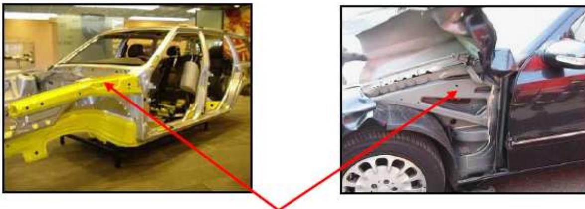
Figura 2-6. Acero HSLA en zona de deformación.<sup>16</sup>
