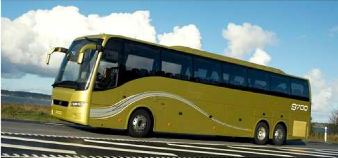
Figura 2-10. Bus Volvo con carrocería de acero inoxidable.<sup>21</sup>
