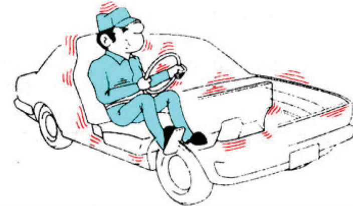
Figura 1.14 Persepcion de vibraciones en el volante de direccion .Fuente. Edgar Mayz, S/F
