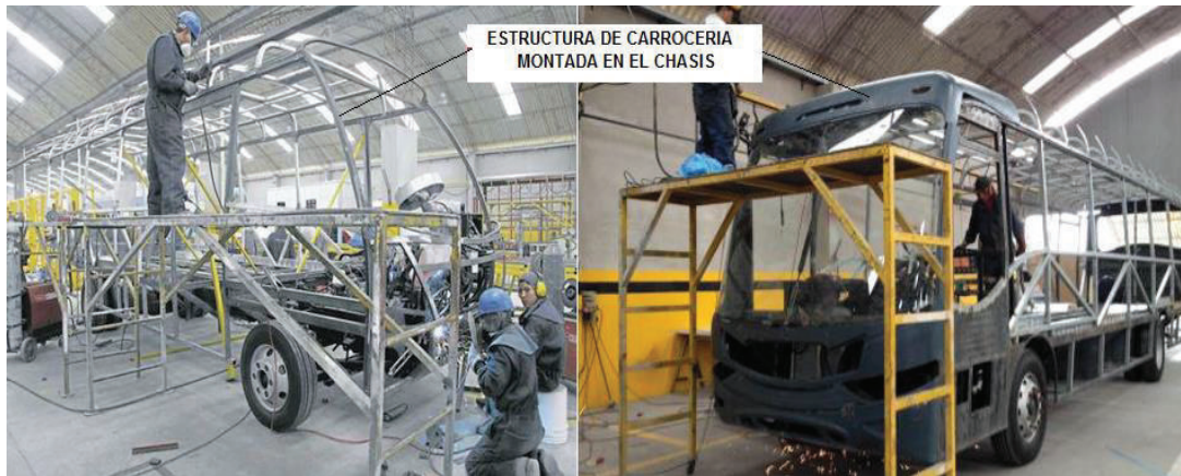
Figura 1.9 Estructura de una carrocería
