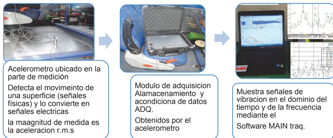
Figura 3.18 Proceso físico de la recopilación de datos de medición de vibraciones
