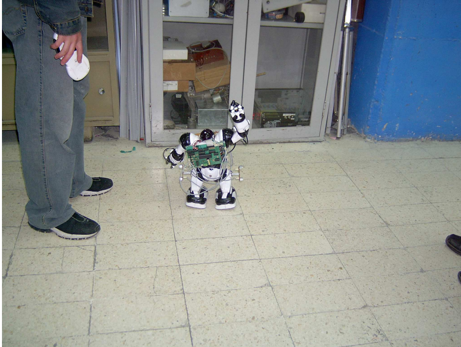
Figura 4.5 Robot deteniéndose ante una superficie de vidrio,
