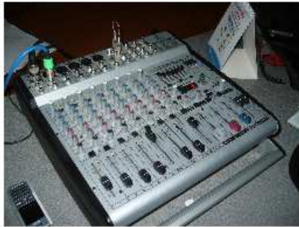
Figura 2.1 Consola mezcladora EURO POWER PMX1000 de Behringer 17
