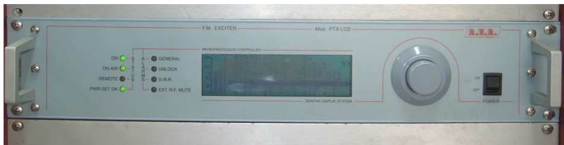
Figura 2.7 Excitador FM PTX-LCD de R.V.R. que funciona en la cabina de transmisión
