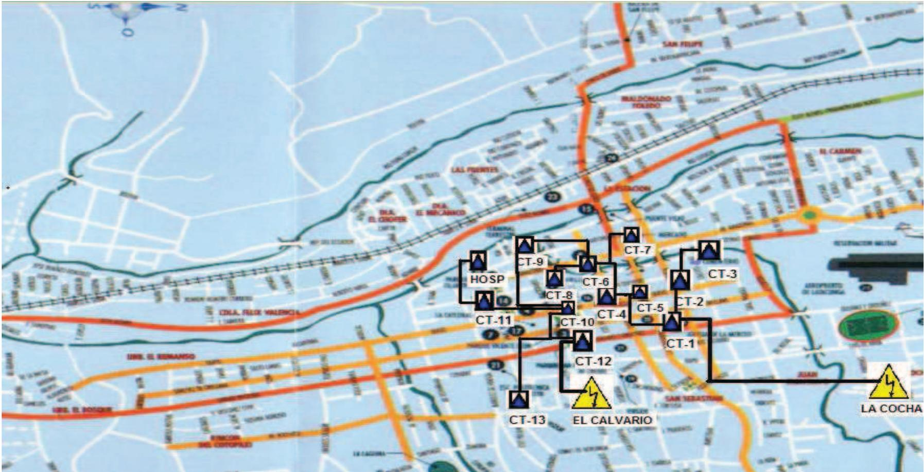
*Figura 4.6: Distribución de las Cámaras de Transformación subterránea*
