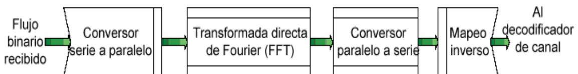
*Figura 2.10: Diagrama de bloques demodulador OFDM*
