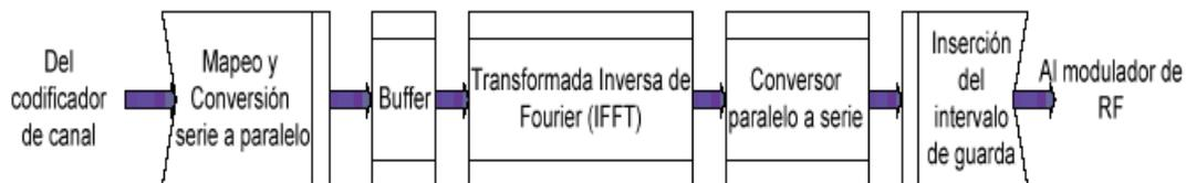
*Figura 2.9: Diagrama de bloques modulador OFDM*
