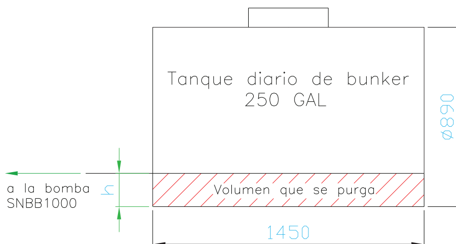
Figura N°5. 2 Volumen que se purga.
