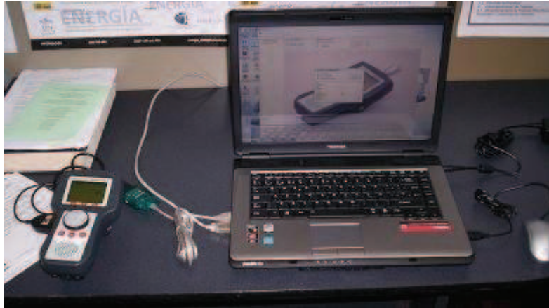
Figura N° F. 2 Conexión del detector de trampas de vapor con la PC.
