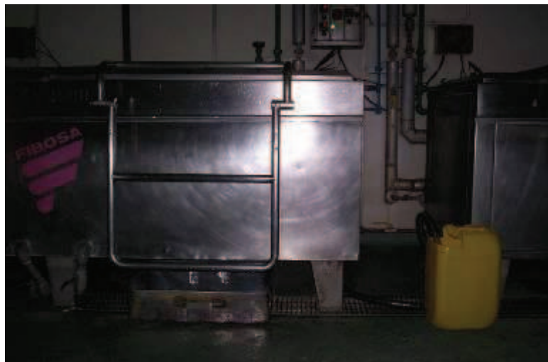
Figura N° F. 6 Caldera de cocción con serpentín HNMA2000 módulo 2 y desviación para medir en condensado durante la cocción de productos.
