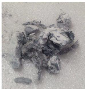
Figura 3. 29 Estroncio metálico con 99% de pureza. (Fuente propia)
