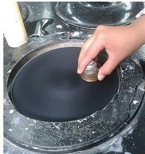
Figura 4. 9 Pulido de la superficie de la probeta. (Fuente propia)
