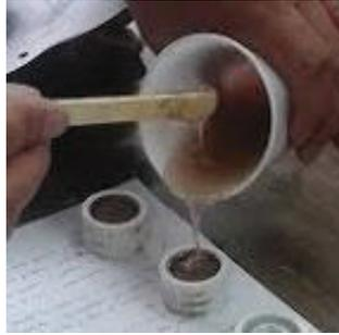
Figura 4. 7 Montaje de la probeta metalográfica. (Fuente propia)
