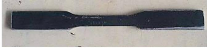
Figura 5. 12 Probeta de tracción de sección rectangular según la norma ASTM E8M-15a. (Fuente propia)
