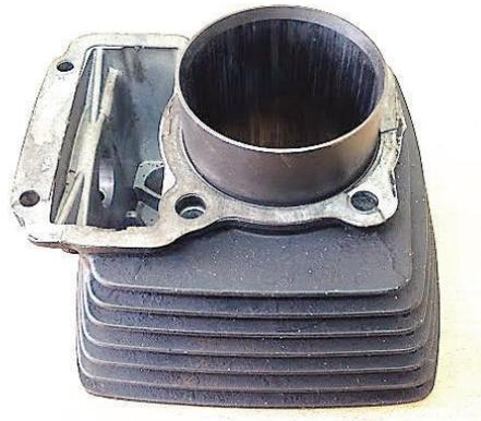
Figura 1. 1 Bloque de cilindro de aleacion de aluminio. (Fuente propia)
