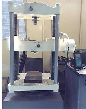
Figura 4. 6 Máquina universal de ensayos. (Fuente propia)
