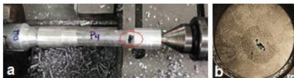
Figura 3. 26 Probetas con porosidad. a) Externa, b) Interna (Fuente Propia)
