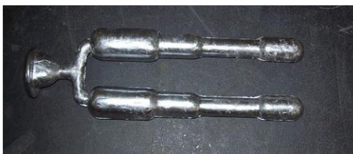
Figura 4. 1 Probeta preliminar como se la obtiene de la coquilla. (Fuente propia)
