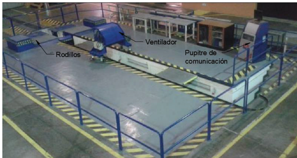
Figura 2. 4. Banco de potencia Maha LPS 3000
