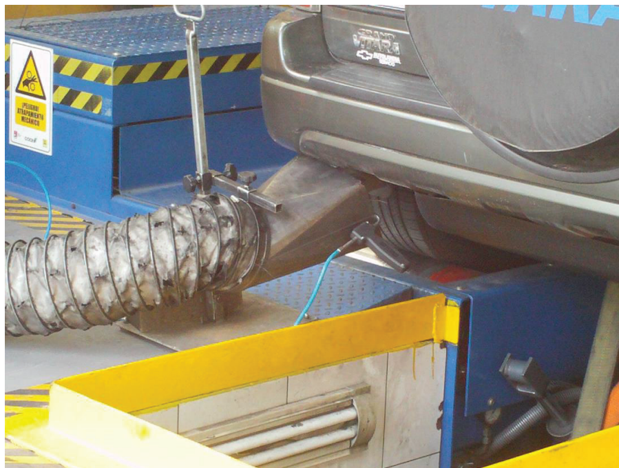
Fig. A3. Vehículo A con la sonda de toma de muestra de emisiones, durante las mediciones tomadas después del convertidor catalítico.
