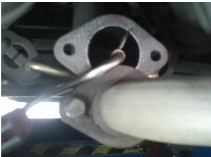
Fig. A5. Sonda de toma de muestra de emisiones, en el vehículo B, para la toma de mediciones antes del convertidor catalítico.
