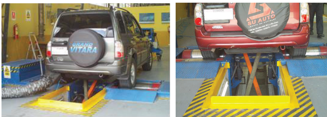
Fig. A2. Vehículos A y B ubicados y sujetos en el dinamómetro antes de las pruebas.
