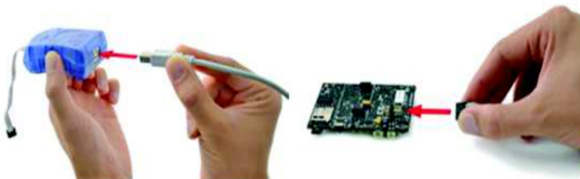
Figura 2.3 Conexión de Waspote y programador AVR para instalación de firmware [16].
