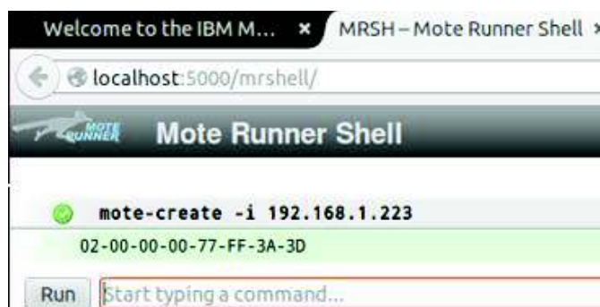
Figura 2.14 Creación del nodo Gateway dentro de la red 6LoWPAN.
