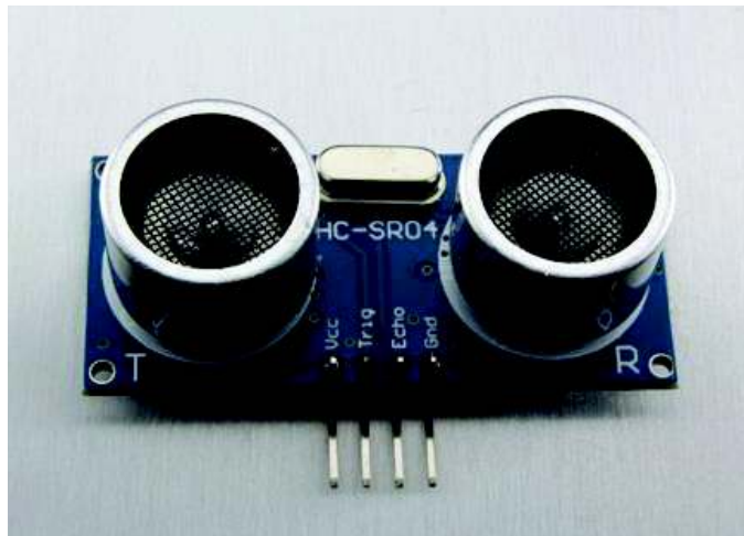
Figura 1.29 Sensor ultrasónico HC-SR04.
