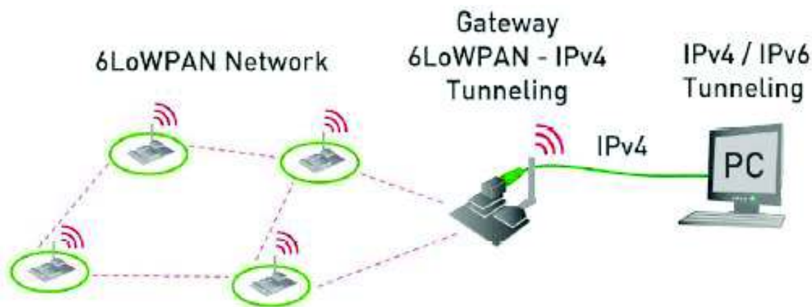
Figura 2.1 Prototipo de red 6LoWPAN a implementarse [16].
