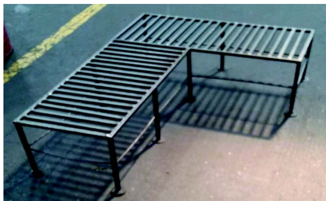
Figura 3.31. Plataforma metálica construida para roscadoras R2 y R3
