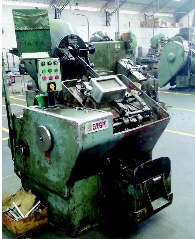
Figura 1.7. Punteadora automática para formar bisel cónico en pernos grado 2 y grado 5
