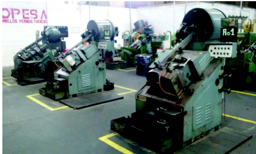
Figura 1.6. Línea de ranurado de tornillos de máquina y pernos grado 2 y grado 5
