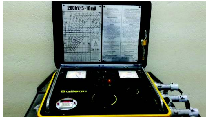
Fotografía 2. 1. Panel o valija de control del laboratorio de END
