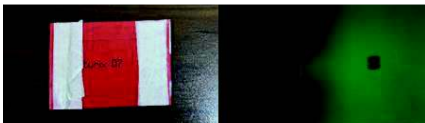
Fotografía 2. 4. Película radiográfica (A la izquierda con su envoltura. A la derecha una película revelada en el cuarto oscuro)
