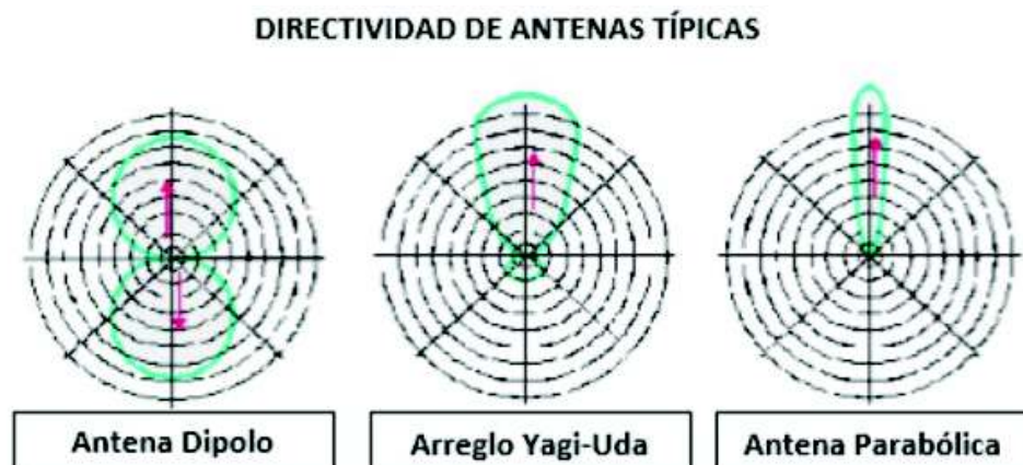
Figura 1. 8 Directividad de diferentes tipos de Antenas [10]
