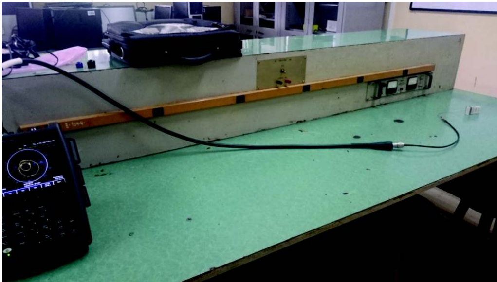
Figura 4. 34 Antena de prueba conectada al Analizador Vectorial
