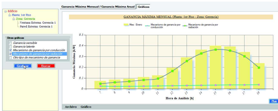
Figura D1.20: Carga total de enfriamiento en conjunto con otras ganancias de interés.
