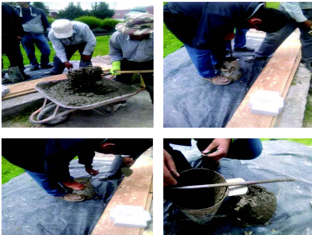
Fotografía 2.1 – Prueba de Revenimiento.
