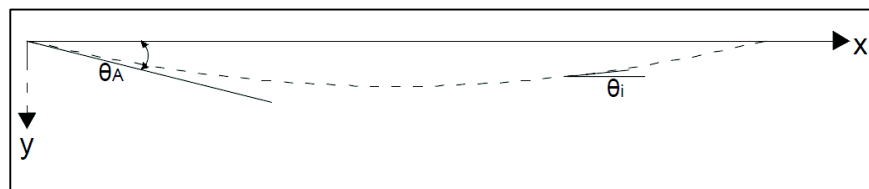
Imagen 2.18 – Pendiente de la deformación de la viga
