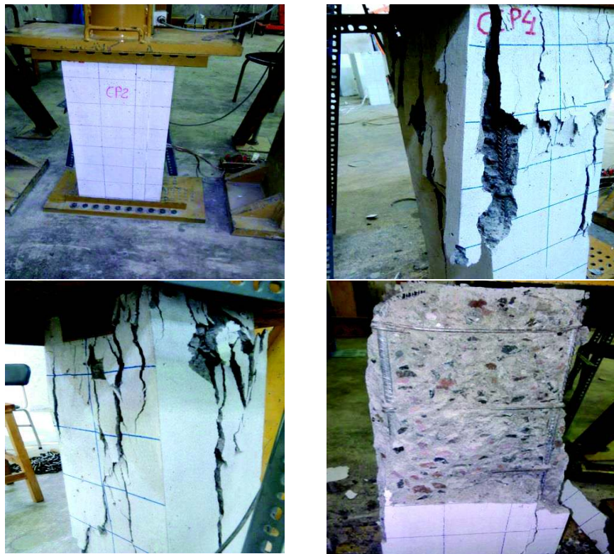
Fotografía 3.35 – Fallas Generadas en la Columnas Prefabricadas de 20x30.
