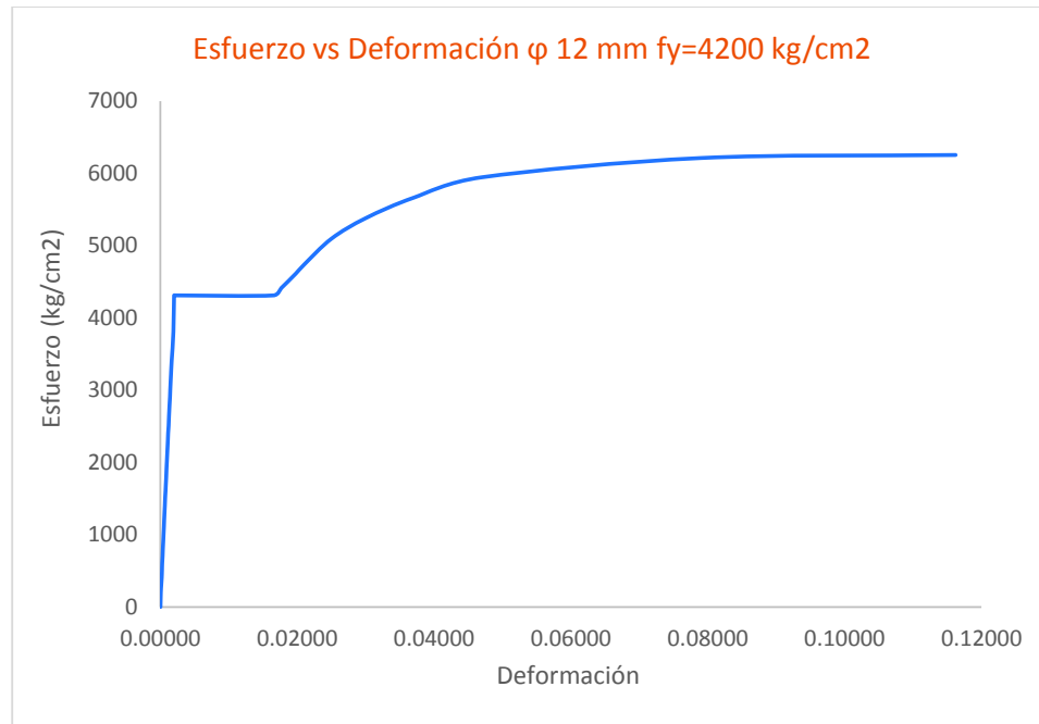
Imagen 2.30 – Gráfica Esfuerzo – Deformación del Acero f_y = 4200 \text{ kg/cm}^2
