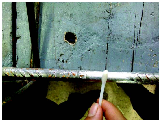
Fotografía 3.14 – Limpieza de Superficie con Acetona Neutra.
