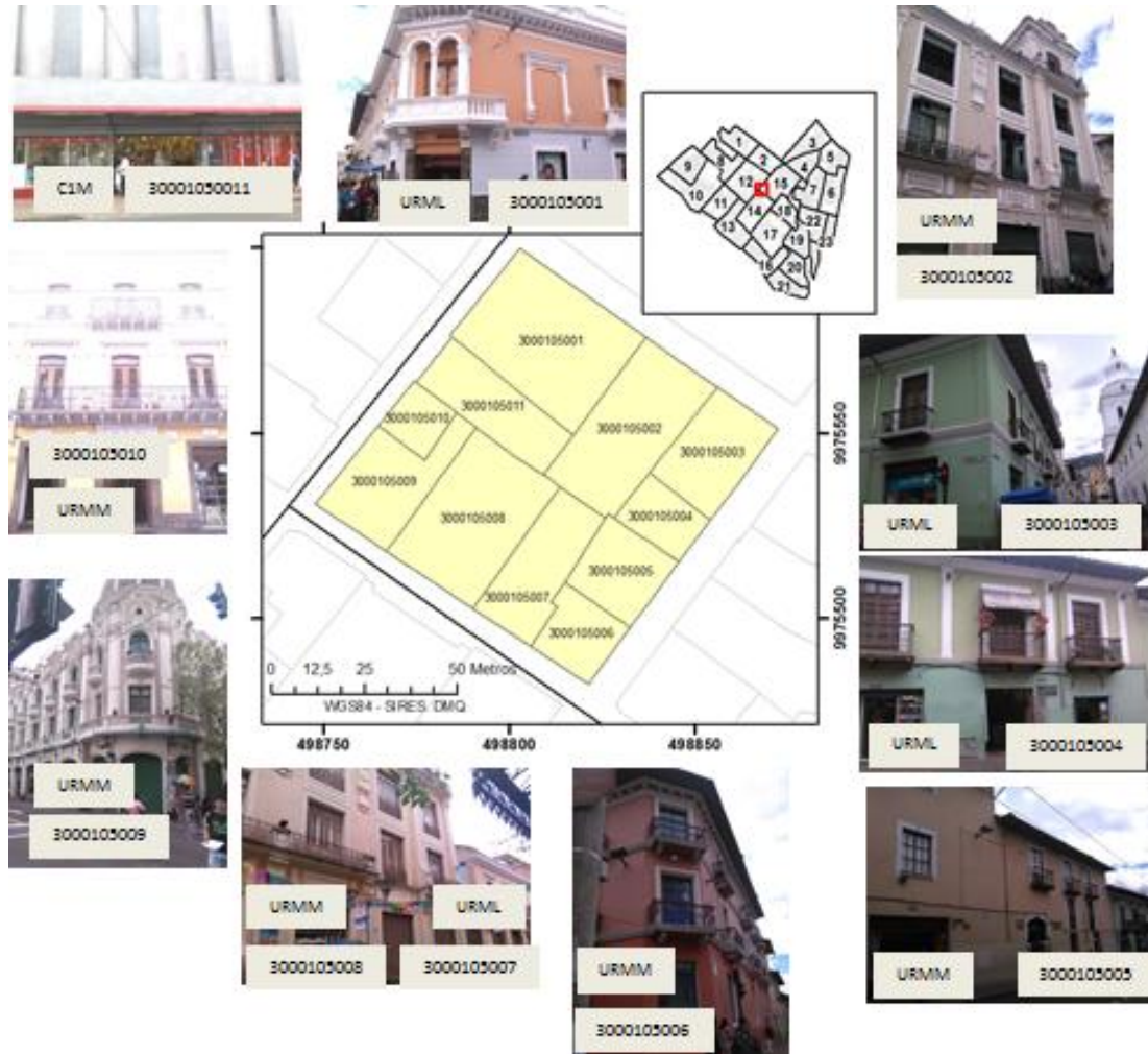
FIGURA No. 23: EJEMPLO DE ASIGNACIÓN DE TIPOLOGÍAS PARA CADA VIVIENDA EN ZONA 15.
