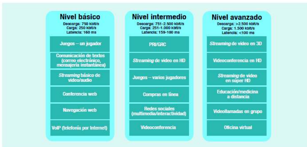
Figura 26 – Nivel técnico y aspecto de la QoS para el uso de cloud (Cisco, 2013)
