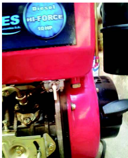
Figura 73. Paso de combustible. Fuente: Barnes de Colombia. Edarvico. S.F.
