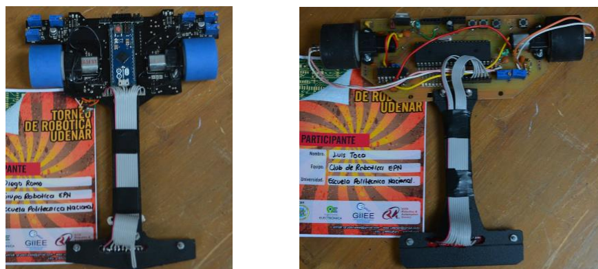
Figura 4.1 Prototipos anteriores, los robots eran muy pesados y tenían problemas de adherencia.
