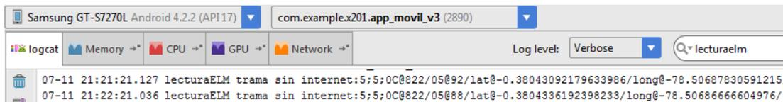
**Figura 4.13** Logs de aplicación móvil en subsistema automóvil al deshabilitar datos móviles
