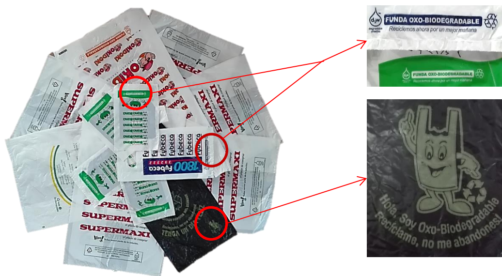
Figura 1.5 Bolsas plásticas de distintos comercios con aditivo pro-oxidante con logos que indican el tipo de bolsa
