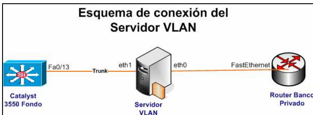
Figura 4.7 Esquema de conexión del Servidor VLAN
