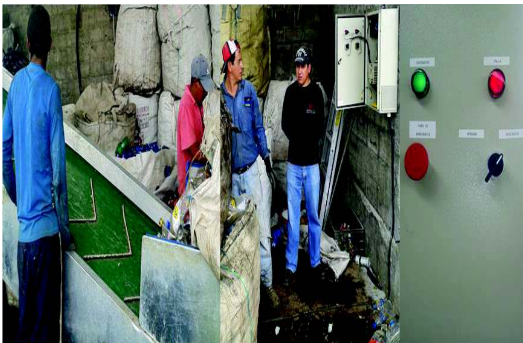
Figura 3.3. Instrucción del encendido y apagado de la banda de selección manual del C.A. de Esmeraldas - Atacames
