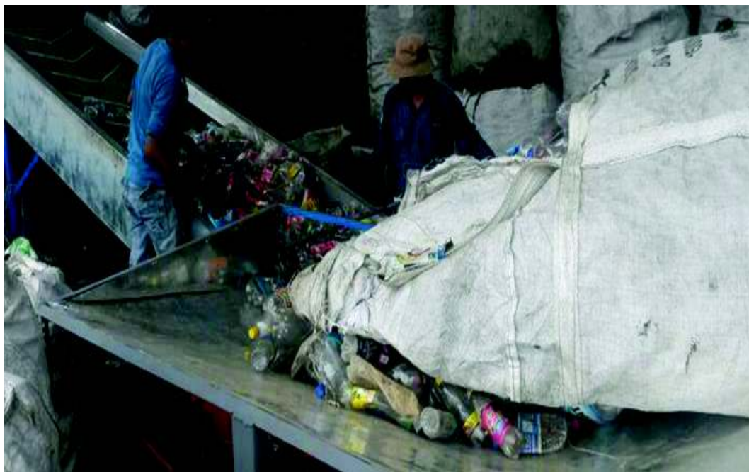
Figura 3.4. Instrucción de la alimentación de big bags de botella PET en la tolva de la banda
