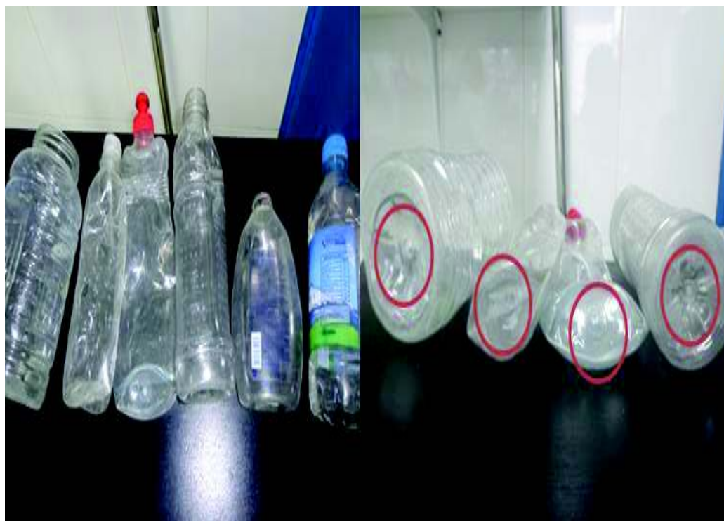
Figura 3.5. Punto de inyección y soplado de botellas PET
