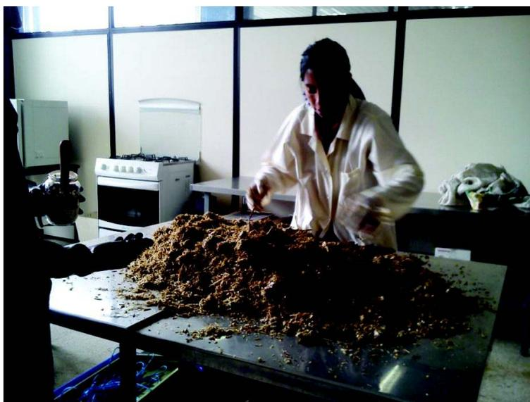
**Figura AIV. 4.** Mezclado del inóculo con el sustrato de rastrojo de maíz y papel
