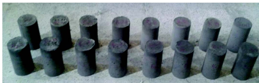
Figura AII. 1. Probetas de los dos experimentos de estabilización/solidificación a los 28 días de curado
