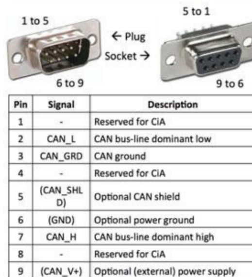
Figura 1.4 Conector DB9 CAN sugerido por la CiA [5]
