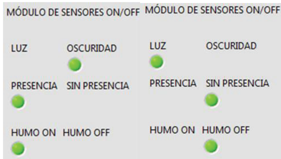
Figura 4.14 Distintos estados de los sensores ON/OFF vistos desde el HMI.
