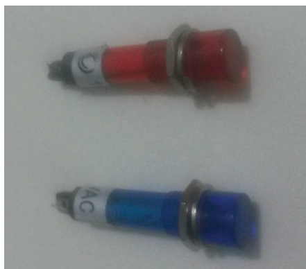
Figura 2.14 Alarmas visuales de nivel máximo y mínimo del nodo CAN de nivel.
