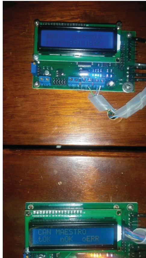
Figura 4.16 Nodo CAN de sensores ON/OFF desconectado.
