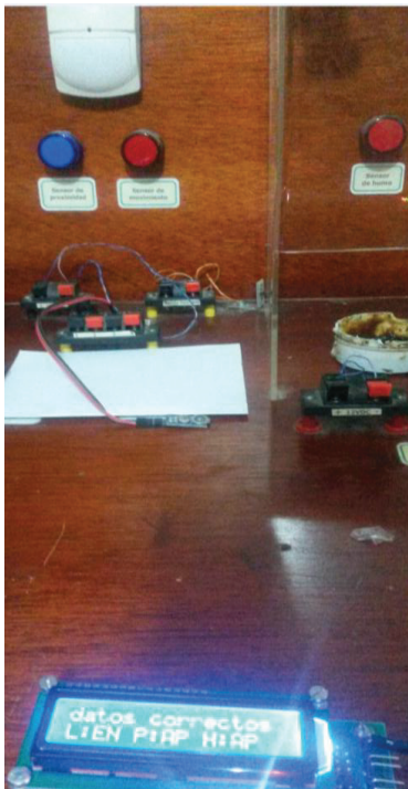
Figura 4.12 Luz encendido, presencia apagado y humo apagado.
