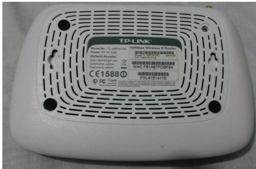
Figura 2.30 Router TL-WR741ND utilizado como switch en la red del módulo [45]
