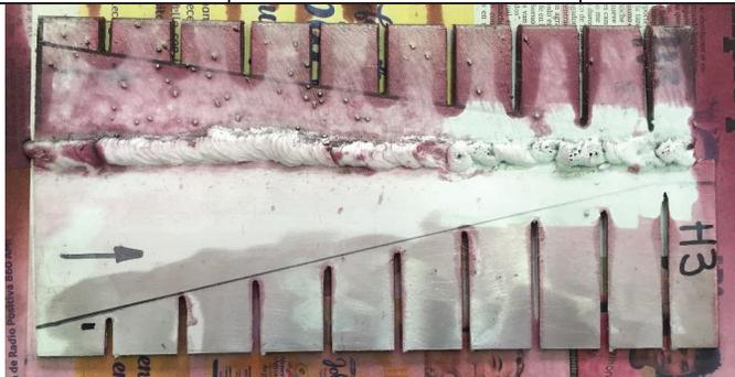
Figura 5.69 - Ensayo de tintas penetrantes en AA6063 y AA6061 sin TT
