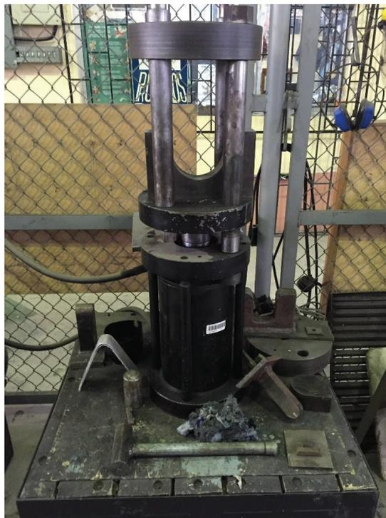
**Figura 5.99** – Equipo de ensayo para doblado guiado
