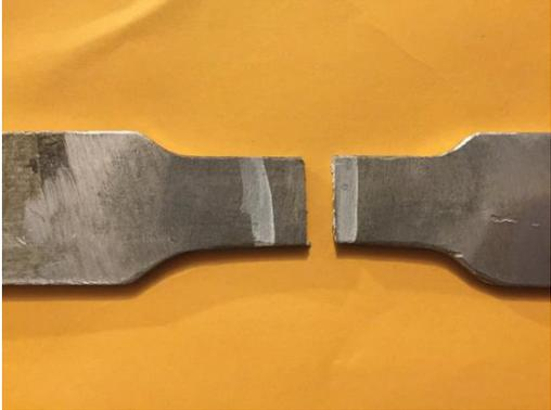
**Figura 5.56** - Fractura en probeta de AA6061 con recocido
