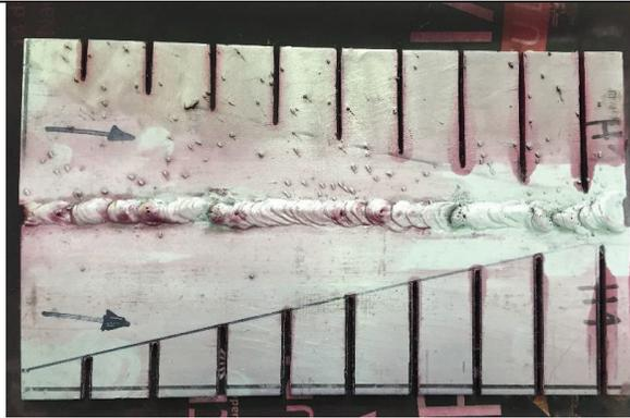
Figura 5.67 - Ensayo de tintas penetrantes en AA6061 sin TT
