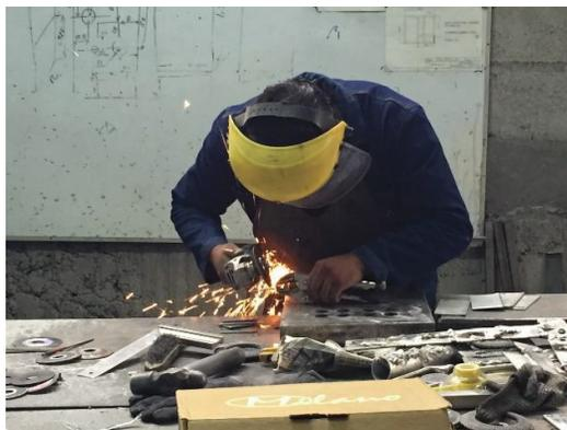
Figura 5.18 – Preparación de las probetas
