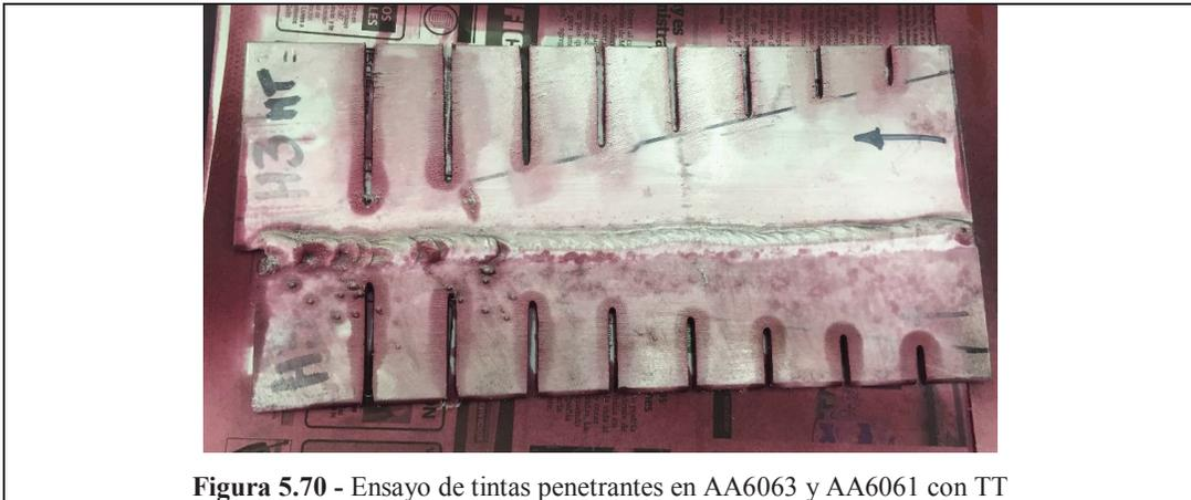
**Figura 5.70** - Ensayo de tintas penetrantes en AA6063 y AA6061 con TT
