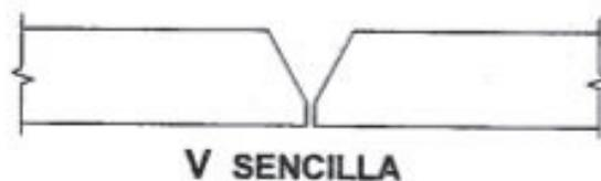
**Figura 4.6** – Bisel en V para juntas de espesor superior a 3mm<sup>17</sup>
