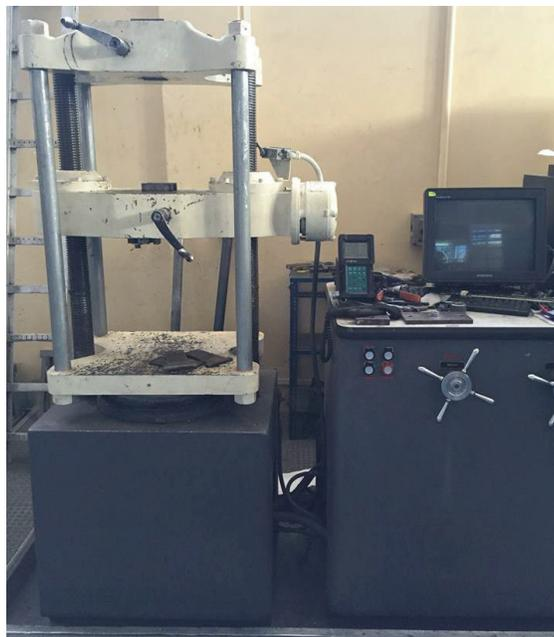
**Figura 5.26** – Máquina universal de ensayos del Laboratorio de Análisis de Esfuerzos y Vibraciones, EPN
