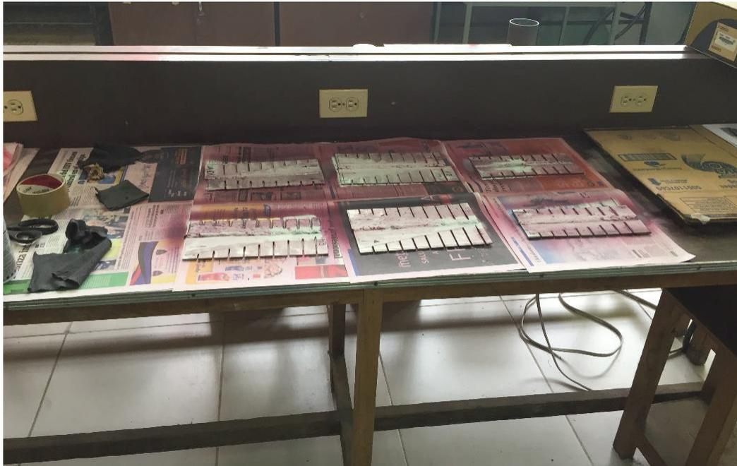
**Figura 5.64** – Aplicación del revelador
