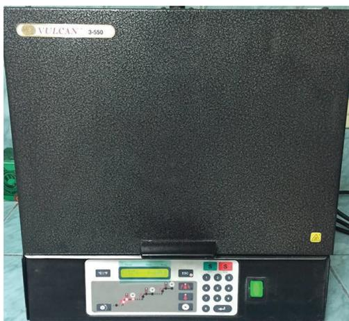
**Figura 5.11** – Horno tipo mufla, marca Vulcan 3-550, Laboratorio de Tratamientos Térmicos, EPN
