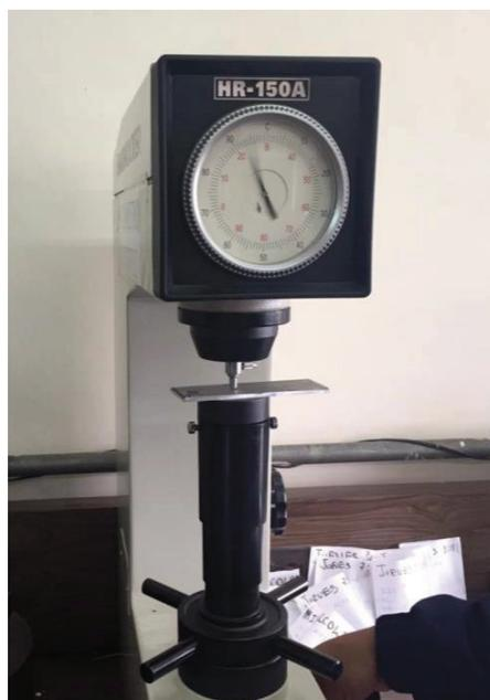
**Figura 5.59** – Realización del ensayo de dureza a una probeta de aluminio AA6061
