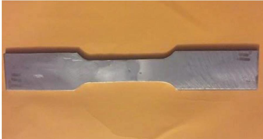
**Figura 5.25** – Modelo de una probeta de tracción con junta soldada
