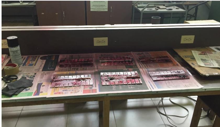
**Figura 5.63** – Probetas con tinta penetrante durante el tiempo de reposo
