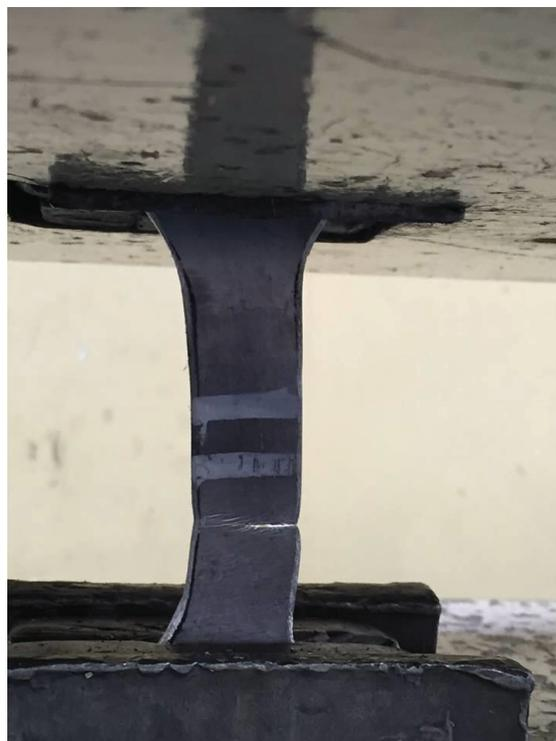
**Figura 5.28** – Probeta con junta soldada al momento de presentar la falla
