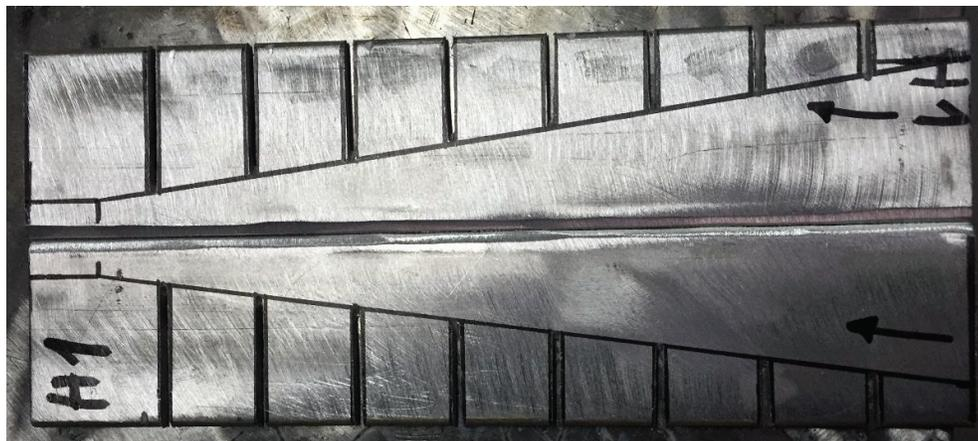
Figura 5.22 – Probetas de AA6061 preparadas para el ensayo Houldcroft
