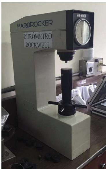
Figura 5.58 – Durómetro Rockwell, marca Hardrocker, modelo HR150A
