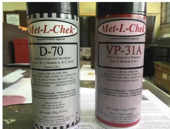
Figura 5.62 – Penetrante y revelador utilizados en el proceso
