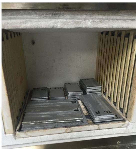
Figura 5.14 – Colocación de las probetas para el tratamiento térmico
