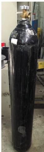
**Figura 5.9** – Tanque de argón al 100% de 7 metros cúbicos
