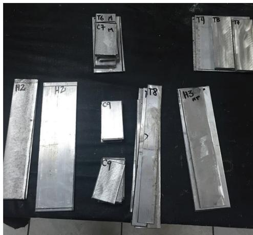
Figura 5.13 – Probetas antes de ser colocadas en el horno de tratamiento
