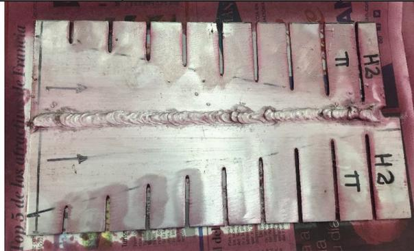
Figura 5.68 - Ensayo de tintas penetrantes en AA6063 con TT
