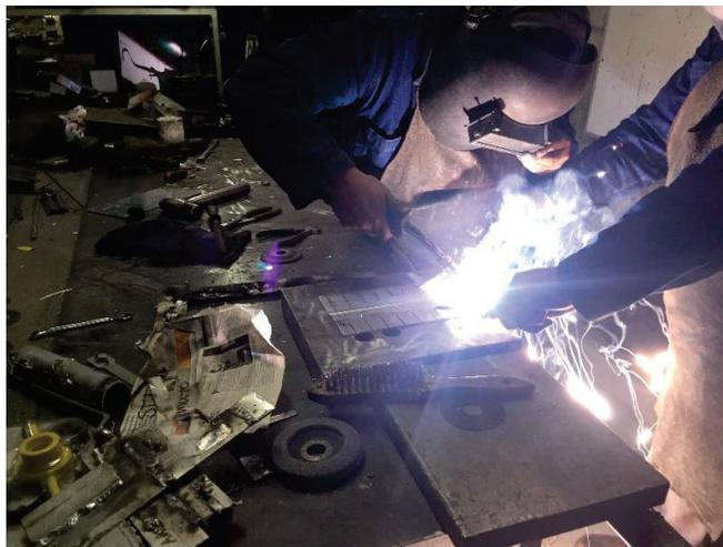
**Figura 5.60** – Procedimiento de soldadura para el ensayo Houldcroft
