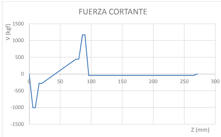
Figura 4.65. Diagrama fuerza cortante del eje pivote de la plataforma general, plano XZ.
