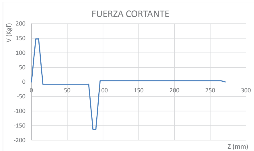
Figura 4.51. Diagrama fuerza cortante del eje pivote de la plataforma general, plano YZ.
