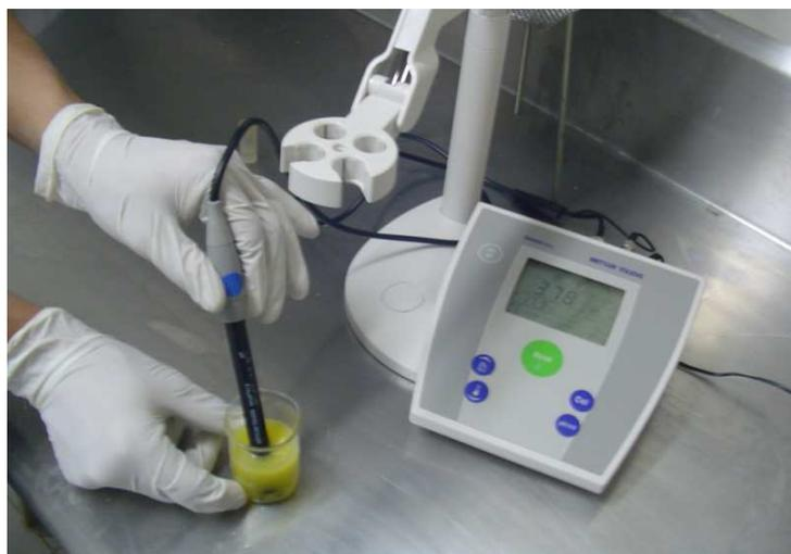
**Figura 21.** Control de Calidad de la pulpa medición del pH
