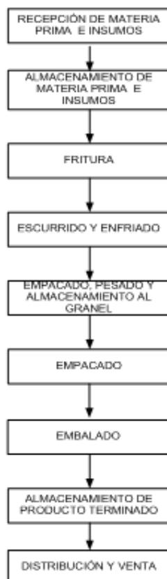
**Figura 5:** Diagrama de bloques del procesamiento de chicharrón.
