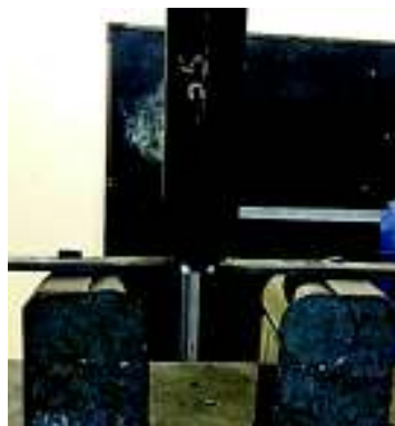
Figura 4.44 Realización del ensayo de doblado en la probeta D_C y D_R .
