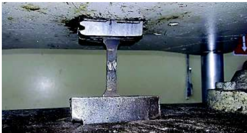
Figura 4.41 Realización del ensayo de tracción para la probeta T_1 y T_2
