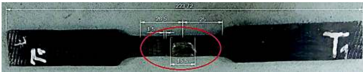
Figura 5.18 Medidas en la rotura de la probeta T_1
