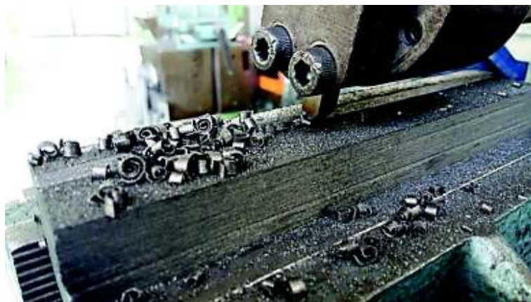
Figura 4.6 Desbaste de probetas en la limadora
