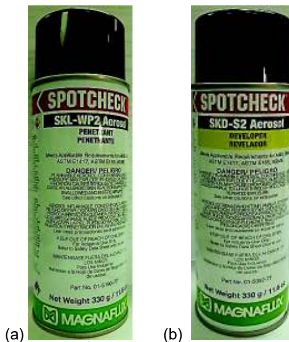
Figura 4.29 (a) Líquido penetrante aplicable al proceso.
