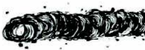
Figura 3.12 Mal aspecto del cordón de soldadura 76
