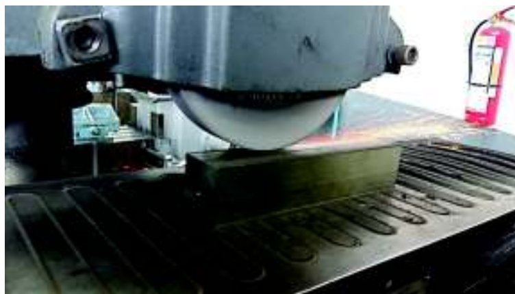
Figura 4.9 Rectificado de bloques de fundición nodular (Fuente propia)
