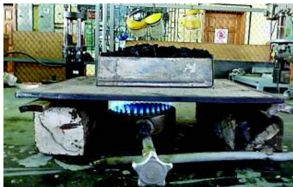
Figura 4.13 Pre calentamiento a 121 °C
