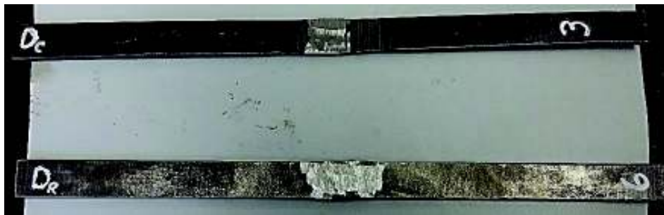
Figura 4.43 Probeta de doblado de cara ( D_C ) y probeta de doblado de raíz ( D_R )
