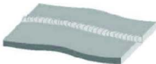
Figura 3.8 Defecto de combadura en piezas soldadas 74
