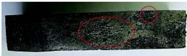
Figura 4.4 Defectos de fabricación en el bloque
