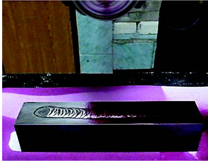
Figura 4.32 Aplicación del líquido penetrante en las probetas
