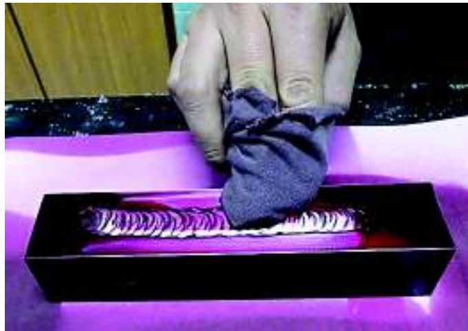
Figura 4.33 Limpieza del exceso de penetrante de cada probeta
