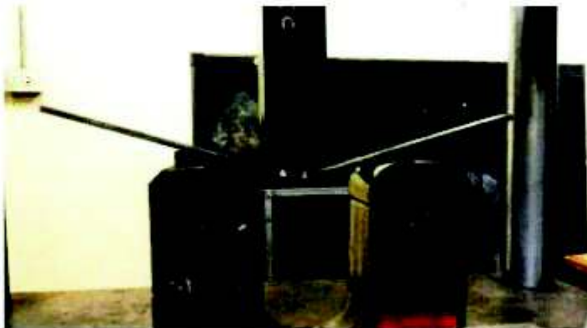
Fotografía 1. Montaje en la máquina universal de ensayos y ángulo en el cual comienza la fisura.
