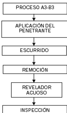
Figura 4.28 Proceso de aplicación A3 y B3 96
