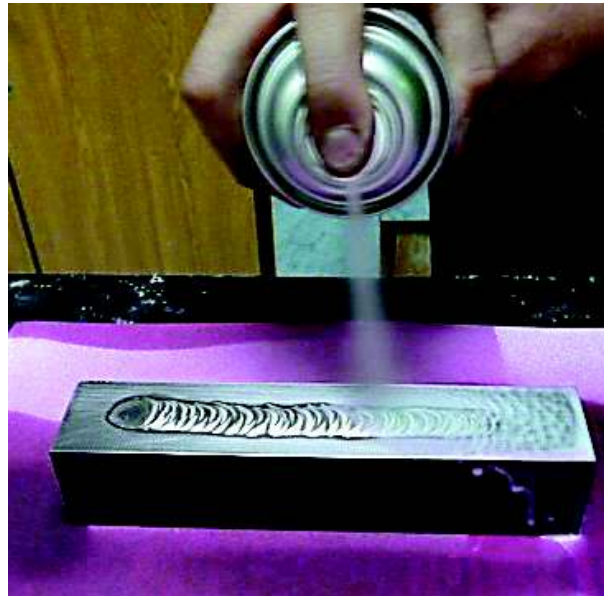
Figura 4.34 Aplicación del revelador sobre cada probeta
