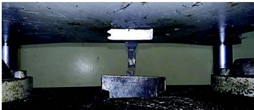
Figura 5.17 Rotura de probeta T 1
