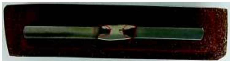
Figura 4.50 Visualización de la zona afectada por el calor en la probeta M_1 (Fuente propia)
