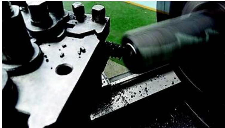
Figura 4.7 Refrentado de las caras opuestas de los bloques
