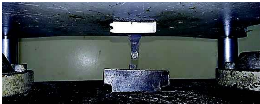
Figura 5.21 Rotura de la probeta T 2
