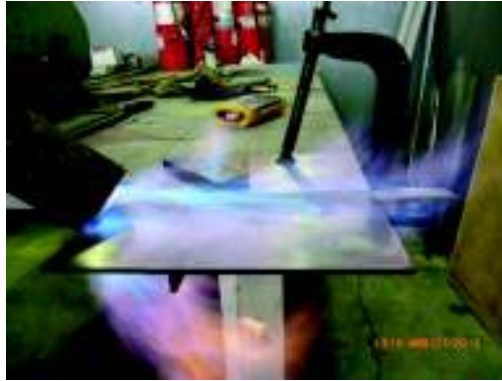
Figura 6.5 Calentamiento de la placa con soplete a gas
