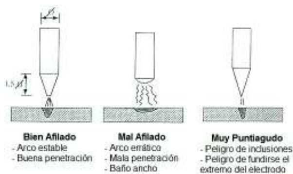
Figura 2.4 Influencia del afilado del electrodo en la soldadura 41
