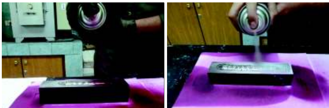
Figura 6.3 Aplicación de tinta penetrante y revelador
