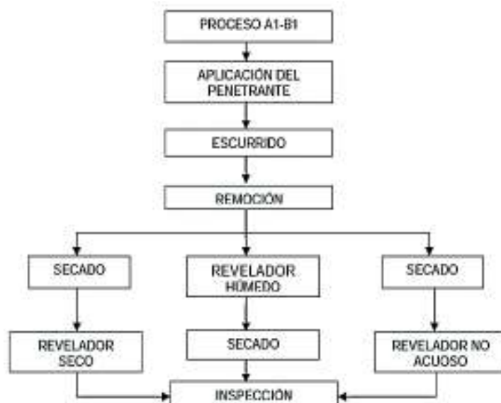
Figura 4.26 Proceso de aplicación A1 y B1 95
