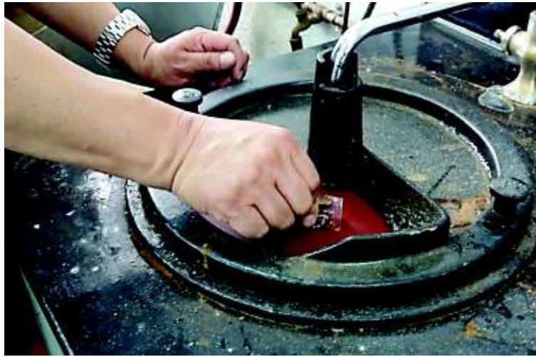
Figura 4.46 Desbaste grueso de las probetas M_1 y M_2
