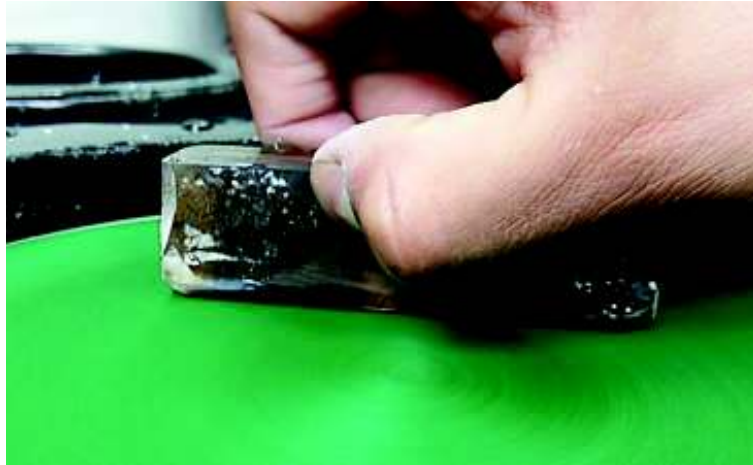
Figura 4.48 Pulido fino de la probeta M_2
