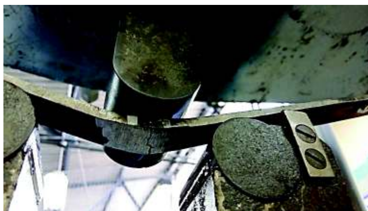
Figura 5.25 Inicio de fisura en la probeta
