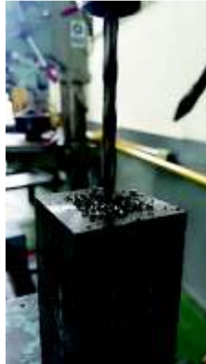
Figura 4.8 Taladrado de probetas (Fuente propia)
