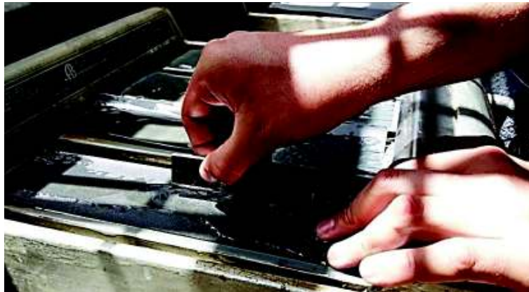
Figura 4.47 Desbaste fino de las probetas M_1 y M_2
