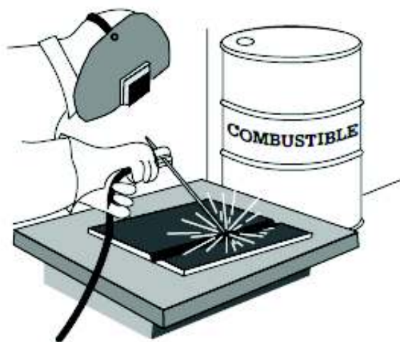
Figura 6.8 Riesgo de incendio al soldar 105
