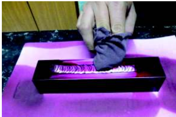
Figura 6.7 Remoción del exceso de tinta penetrante
