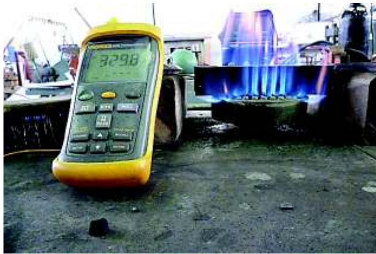
Figura 4.14 Precalentamiento a 327 °C
