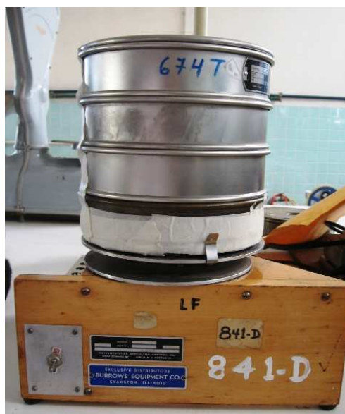
Figura 17. Tamices y agitador utilizados en el análisis de granulometría de las muestras de panela granulada
