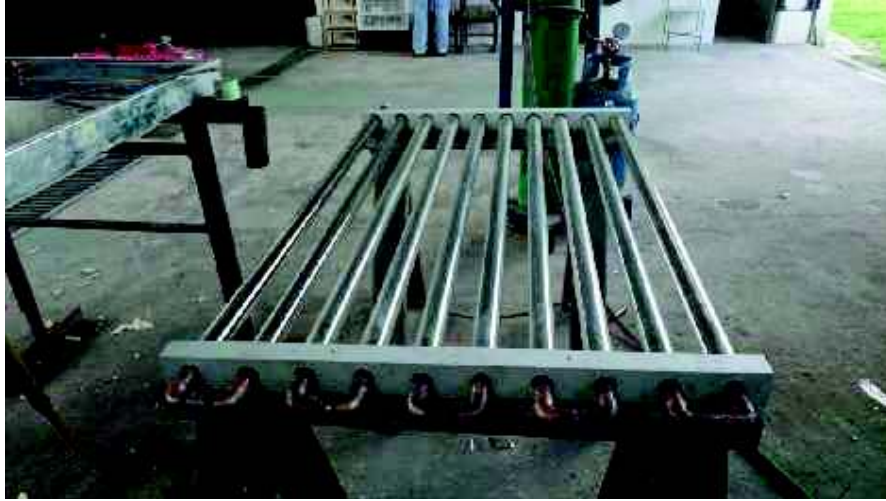
Figura 4.3. Construcción del absorbedor.
