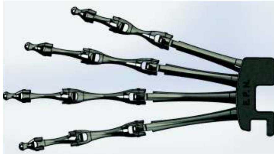
Fig. 2.11-a: Ensamble de los 4 dedos con el carpo y el metacarpo Fuente: Propia
