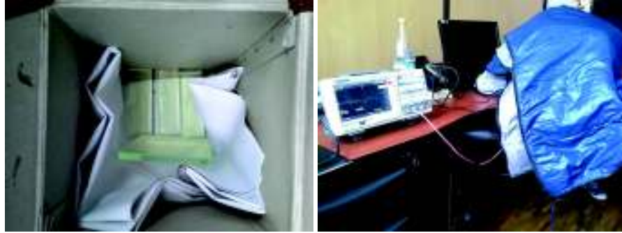
Figura 6.17: Montaje experimental para realizar las pruebas con osciloscopio del funcionamiento del PMT.
