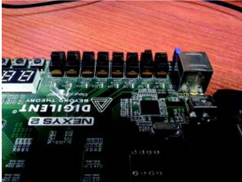
Figura 6.15: Posición de los interruptores de la tarjeta de adquisición de datos FPGA.
