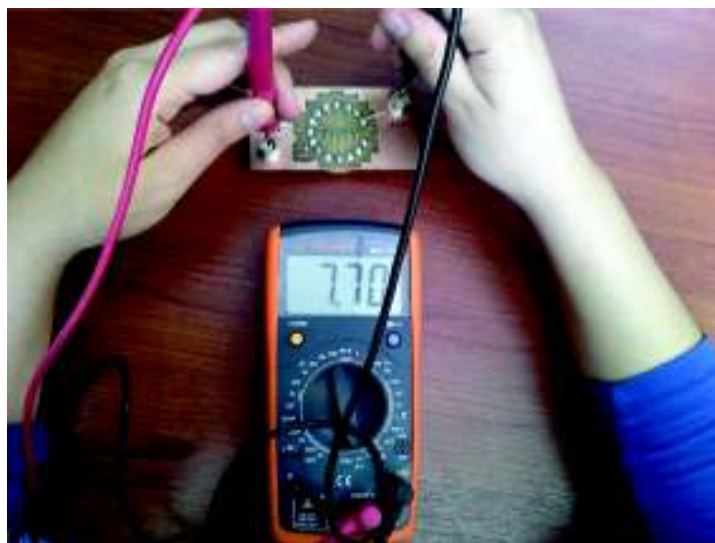
Figura 6.12: Pruebas con multímetro de la base del Fototubo multiplicador.
