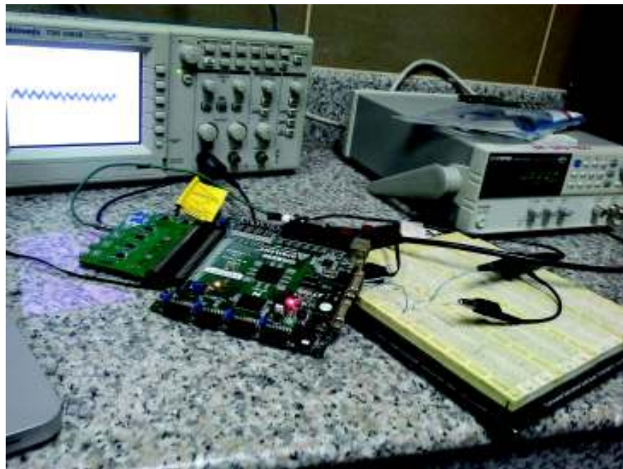
Figura 6.14: Prueba de la tarjeta de adquisición de datos con generador de funciones y osciloscopio.
