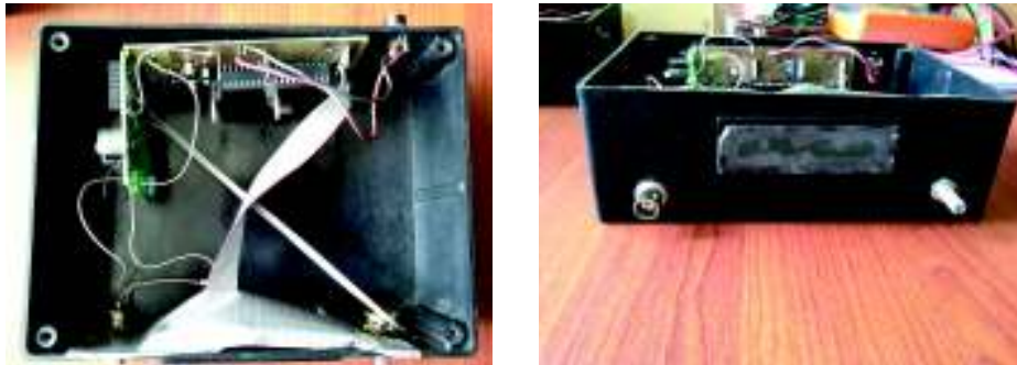
Figura 6.9: Fuente de alto voltaje utilizada en el experimento y desarrollada como parte del proyecto EAS-BUAP.
