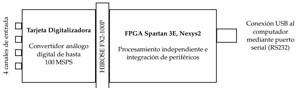
Figura 6.11: Descripción visual gráfica de la tarjeta de adquisición de datos desarrollada en [14]
