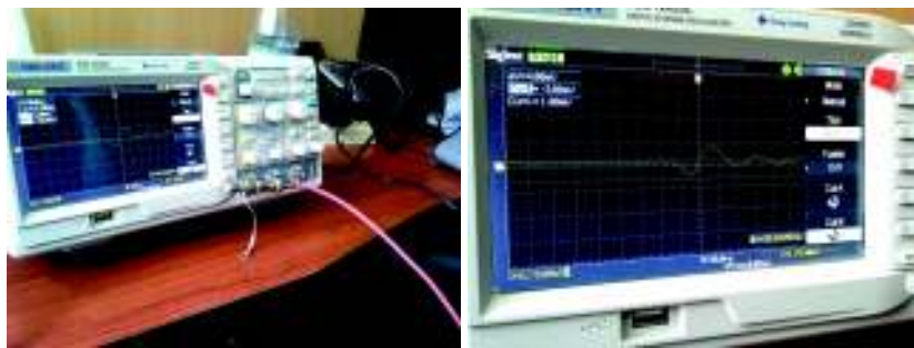
Figura 6.18: Datos tomados directamente de la señal de salida del PMT en el osciloscopio. Pulso con rebote de señal.
