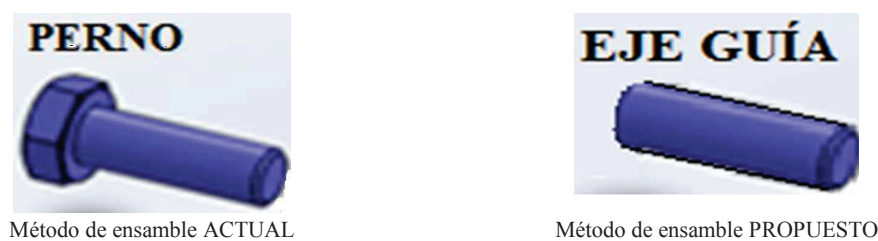
Figura 3.11. Cambio de elemento para el ensamble de las ruedas con base horizontal de 1"1/2 a 3"
