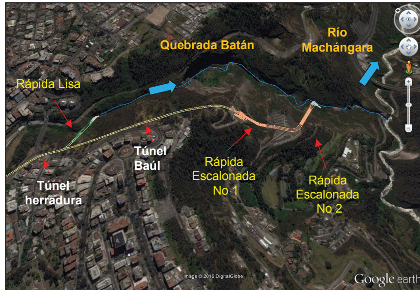
FIGURA 4.1 UBICACIÓN DEL SISTEMA DE DESCARGA DE LAS AGUAS COMBINADAS CON RÁPIDA ESCALONADA Y LISA HACIA LA QUEBRADA EL BATÁN.
