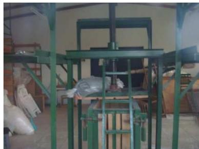
**Figura 43.** Fotografía de una prensa usada para acondicionar los fardos de pelo de conejo
