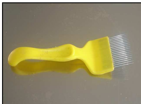
Figura 19: Peine Desoperculador con dientes de acero inoxidable Apícola Santa Anita.
