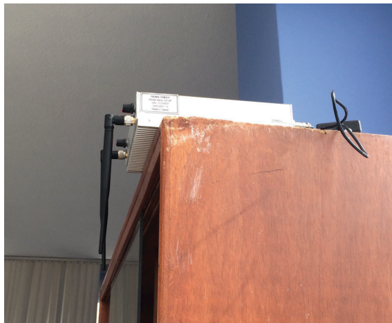
Figura 4. 120 Inhibidor con polarización vertical
