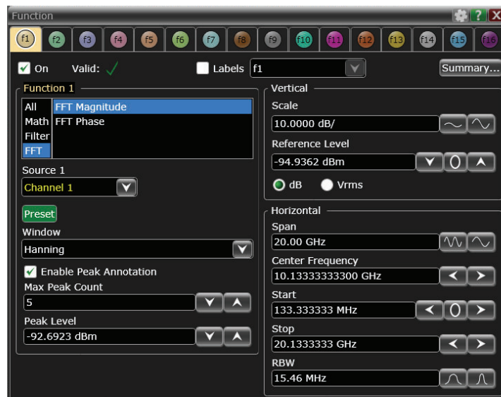
Figura 4. 85 Configuración del análisis de frecuencia de la señal
