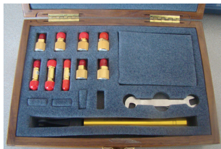
Figura 4. 20 Caja kit de calibración 85052 D vista interna
