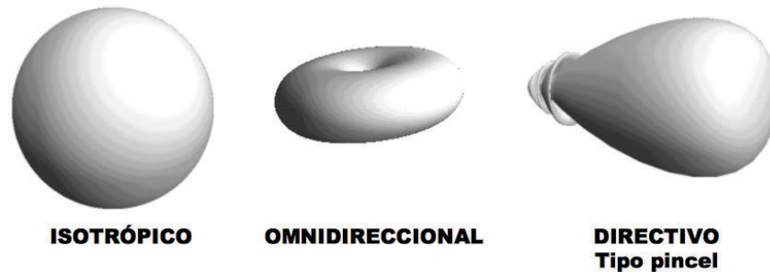
Figura 2. 8 Representación gráfica de las características de radiación de las antenas[6]
