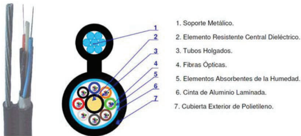
Figura 2.1 Estructura cable con mensajero 34
