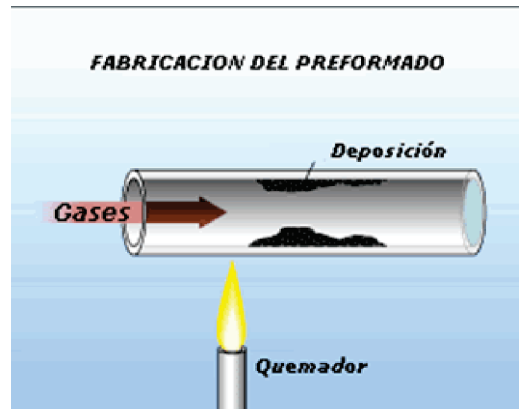
Figura 1.3 Esquema método de Deposición de Vapor 2
