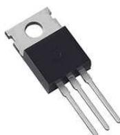
Figura 2-11 Regulador de voltaje LM7805
