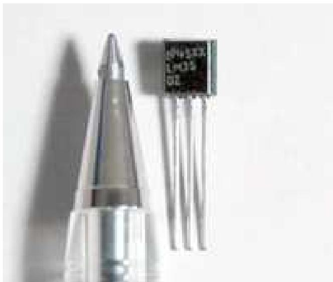
**Figura 2-19** Sensor de temperatura LM35
