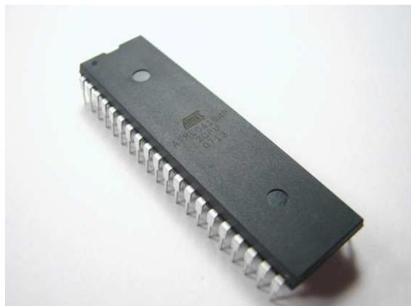
**Figura 2-18** Microcontrolador ATmega 164P
