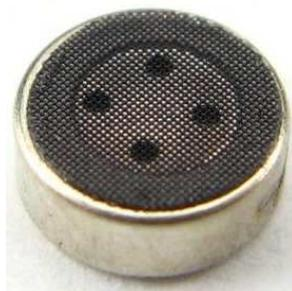
**Figura 2-35** Micrófonos tipo electret utilizados en teléfonos celulares.
