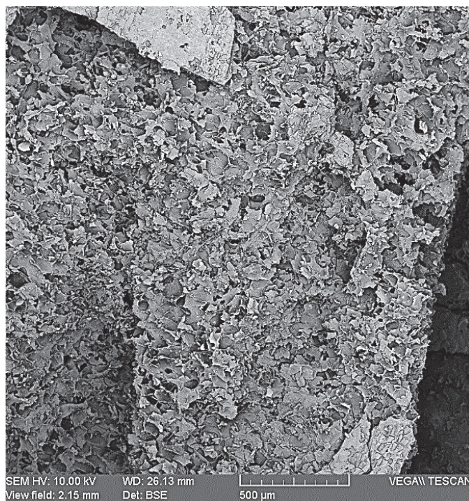
Figura FTXVI.1 Carbón obtenido bajo las mejores condiciones de pirólisis ( C_{SA} ) a un aumento de 100x
