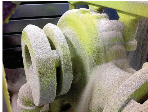
Figura 2.10 Patrón de poliestireno recubierto con una capa de cerámica (Fuente: http://www.precisionalloys.uk/process )
