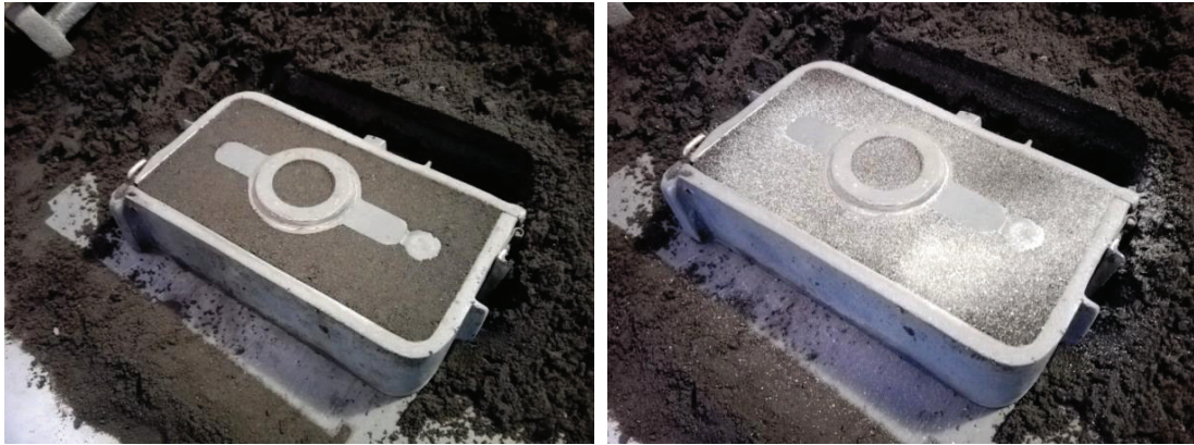
Figura 3.10 Izquierda. Vista del patrón en la mitad del molde.
