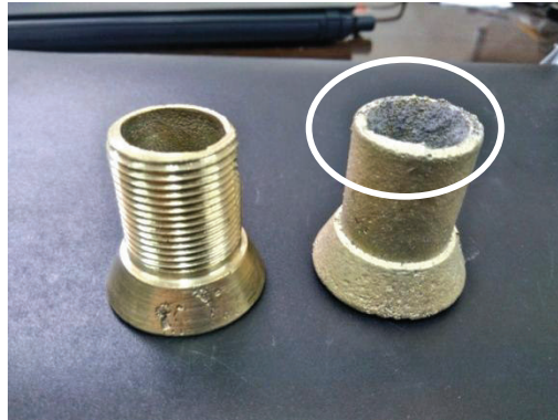
Figura 2.12 Inclusiones en pieza fundida (Fuente: Propia)
