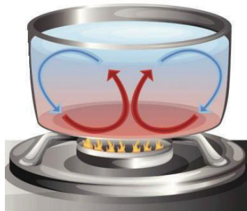
Figura 2.18 Ejemplo de transferencia de calor por convección
