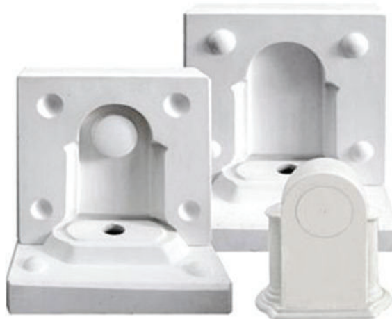
Figura 2.3 Molde fabricado con yeso
