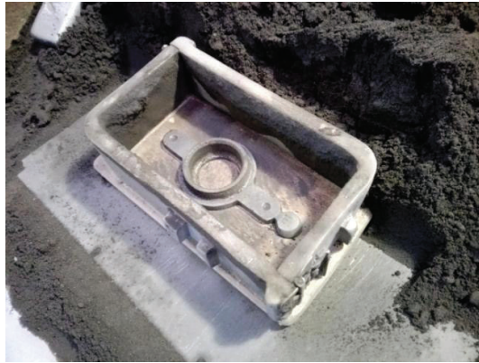
Figura 3.8 Patrón centrado dentro del bastidor para moldeo.
