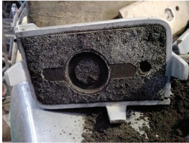
Figura 3.14 Mitad superior del molde con la cavidad perfectamente moldeada.
