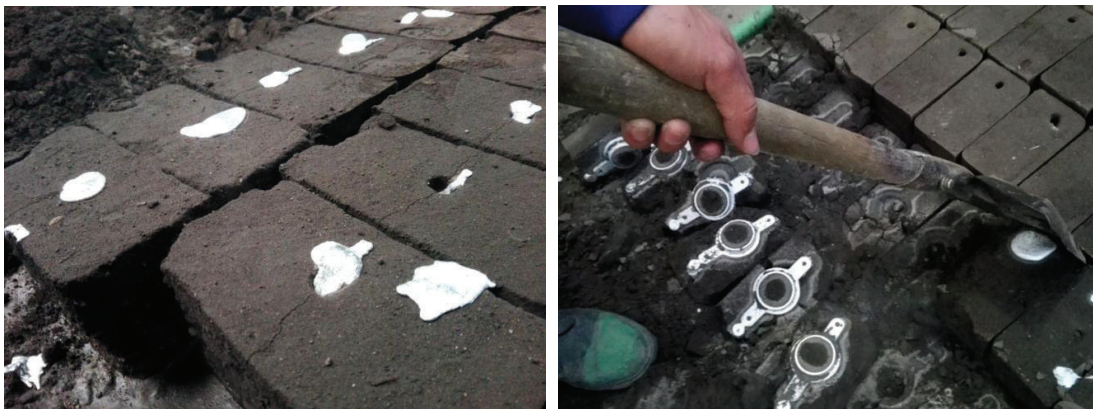
Figura 3.19 Izquierda, metal del bebedero solidificado Derecha, rompimiento del molde (Fuente: Propia)
