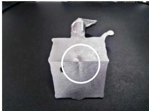
Figura 2.13 Contracción en pieza fundida (Fuente: Propia)
