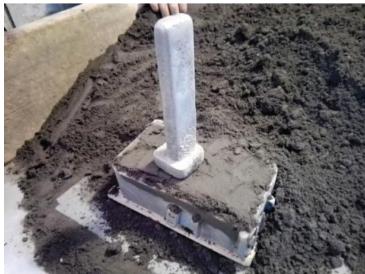
Figura 3.9 Arena apisonada dentro del bastidor
