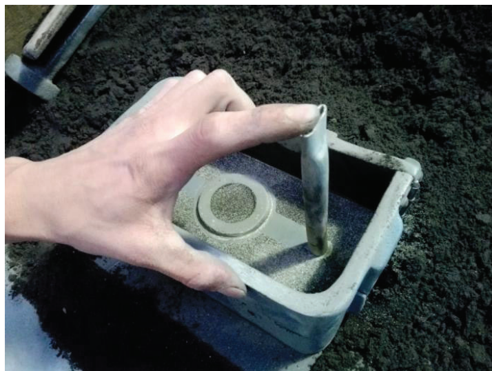
Figura 3.11 Colocación del patrón del bebedero en su posición.
