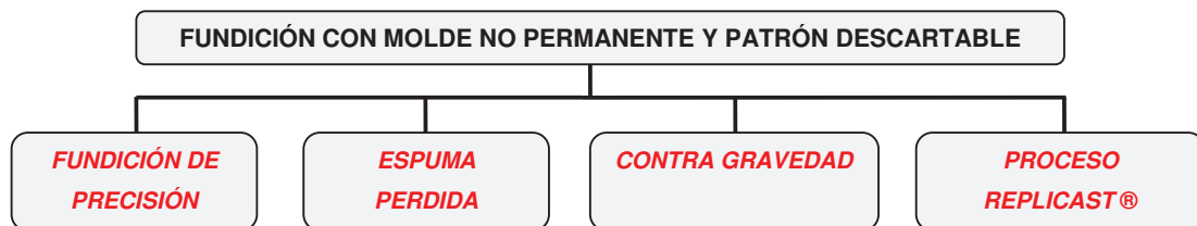
Figura 2.6 Tipos de fundición con moldes no permanentes y patrón descartable (Fuente: ASM International, Casting design and performance. Pág. 10)
