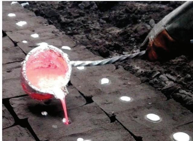
Figura 3.18 Vertido del metal fundido en el molde (Fuente: Propia)
