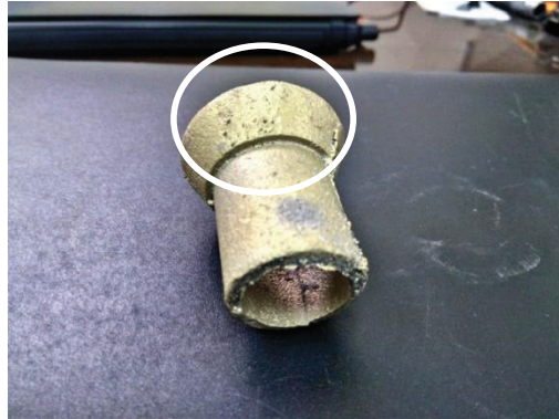
Figura 2.14 Porosidades en pieza fundida (Fuente: Propia)
