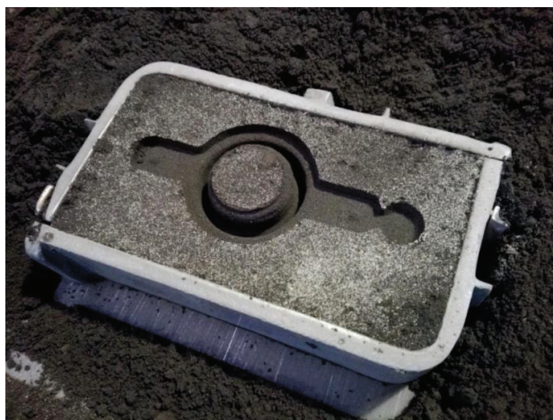
Figura 3.13 Mitad inferior del molde con la cavidad perfectamente moldeada. (Fuente: Propia)
