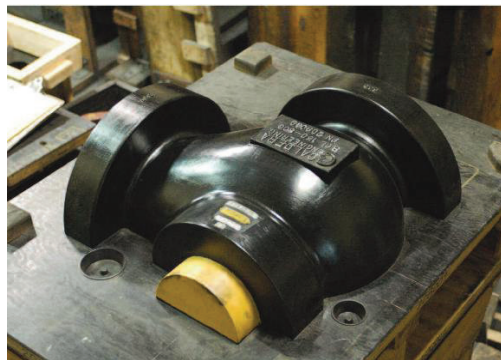
Figura 2.4 Patrón de madera usado para producir un molde de grafito apisonado
