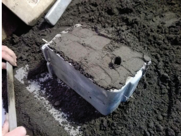
Figura 3.12 Molde listo para remoción de excesos de arena. (Fuente: Propia)
