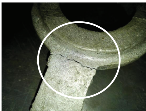
Figura 2.16 Desgarre en pieza fundida (Fuente: Propia)
