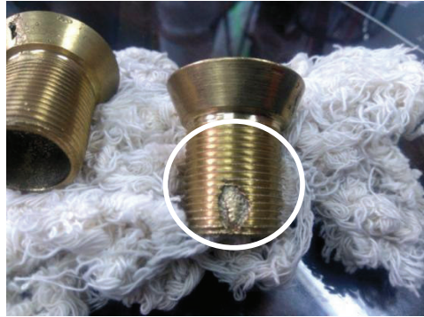
Figura 2.17 Bucle en pieza fundida maquinada (Fuente: Propia)
