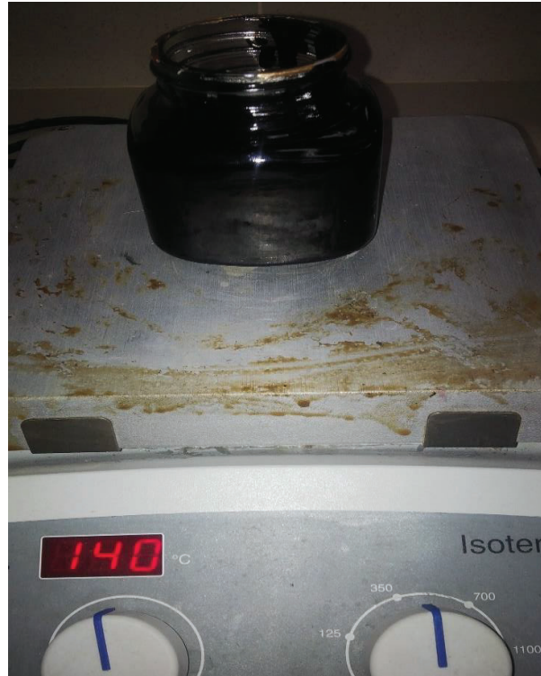
Fotografía 8. Control de temperatura del crudo
