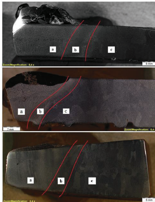
Figura 14.- Macrografías de las muestras recargadas con: varilla de aporte de carburo de tungsteno atacada con Nital al 10% durante 5 segundos, soldadura de arco eléctrico atacada con Nital al 10% durante 7 segundos, y con termorociado con polvos de carburo de tungsteno atacada con Nital al 10% durante 5 segundos. Se observan: a) zona templada al aire, b) ZAC y c) formación de estructura granular.
