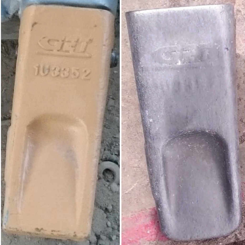
Figura 24.- Comparación de la punta original luego de 77 horas trabajadas en el equipo.
