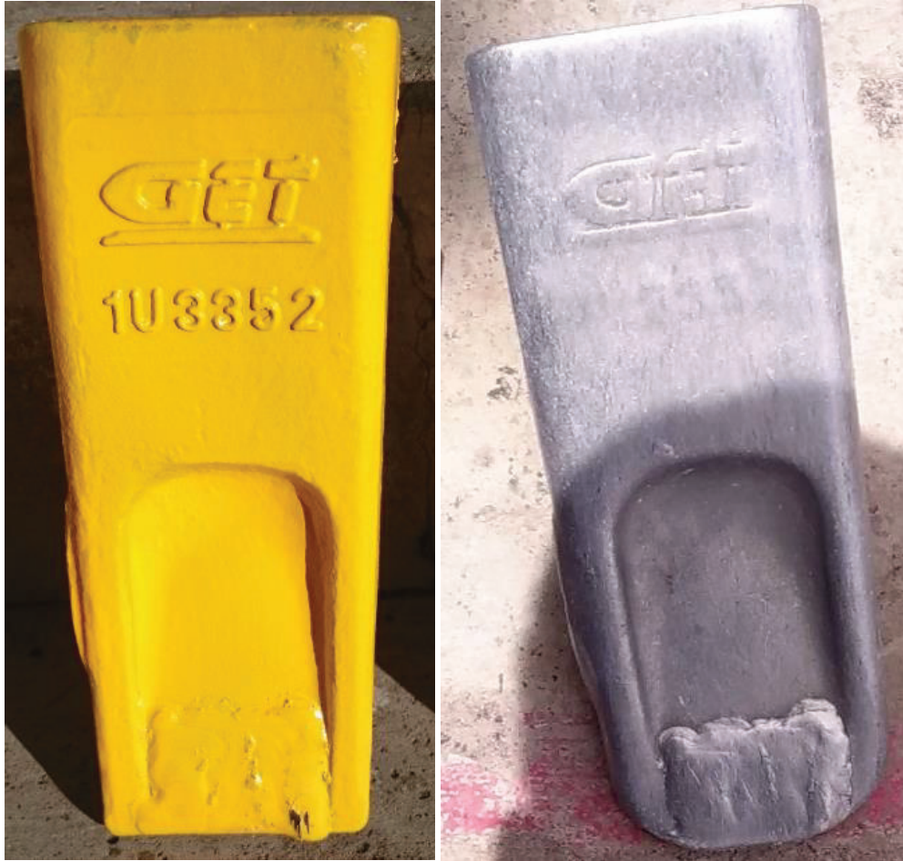
Figura 22.- Comparación de la punta reforzada con suelda de arco eléctrico luego de 77 horas de trabajo.
