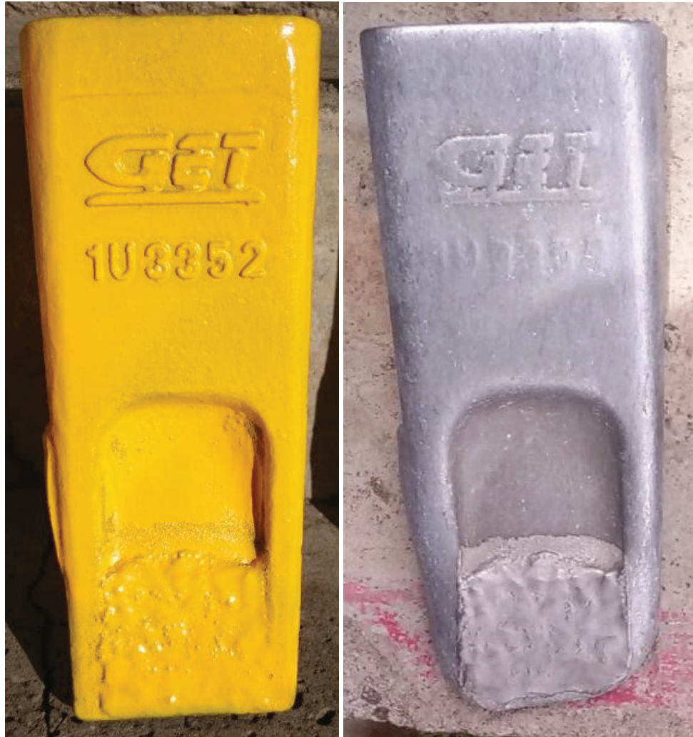
Figura 23.- Comparación de la punta reforzada por termorociado con polvos de carburo de tungsteno luego de 77 horas de trabajo.
