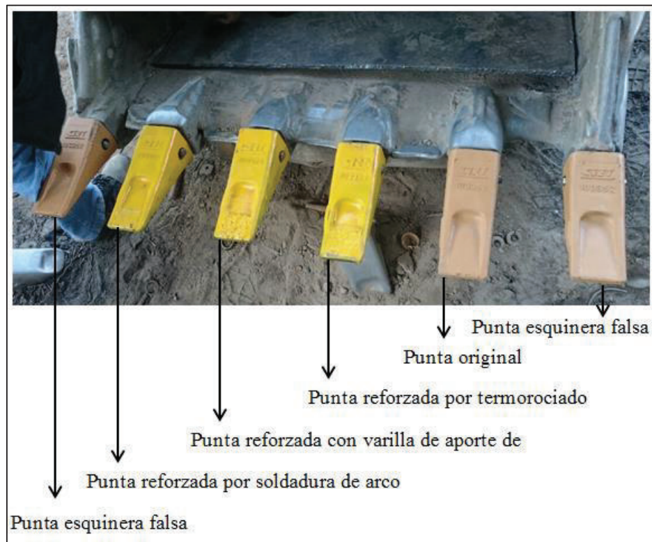
Figura 5.- Montaje de las cuatro puntas para la prueba de campo en un cucharón de una excavadora CATERPILLAR 320D con seis adaptadores.
