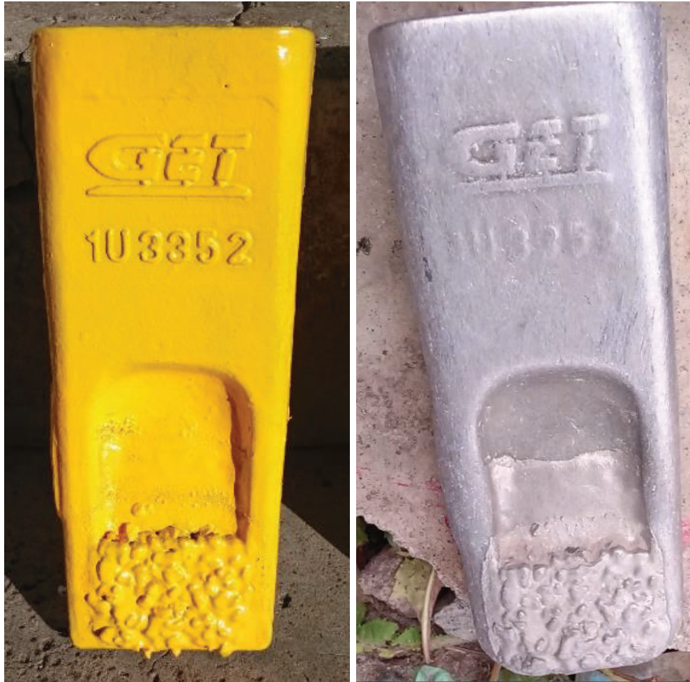
Figura 21.- Comparación de la punta reforzada con varilla de aporte de carburo de tungsteno luego de 77 horas de trabajo.
