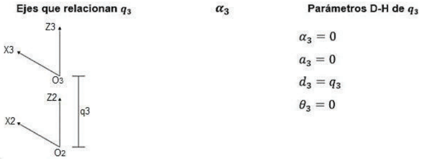
Figura 2.11 Parámetros D-H del grado q_3 del brazo UPE
