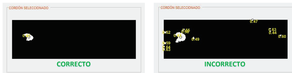
Figura 4-30. Selección Correcta e Incorrecta de la Sensibilidad.
