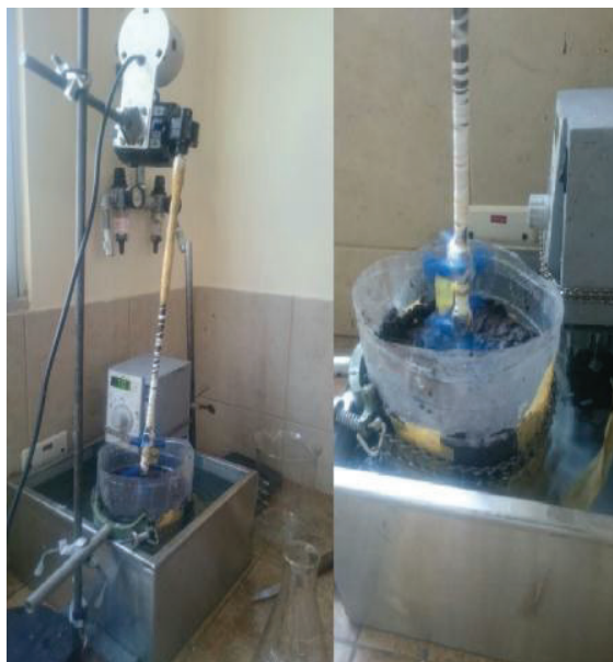
Figura 2.4. Montaje de equipos para el teñido de las VWB
