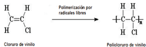
Figura 1.7. Reacción de polimerización del PVC (Wilkes et al., 2005, p.1)
