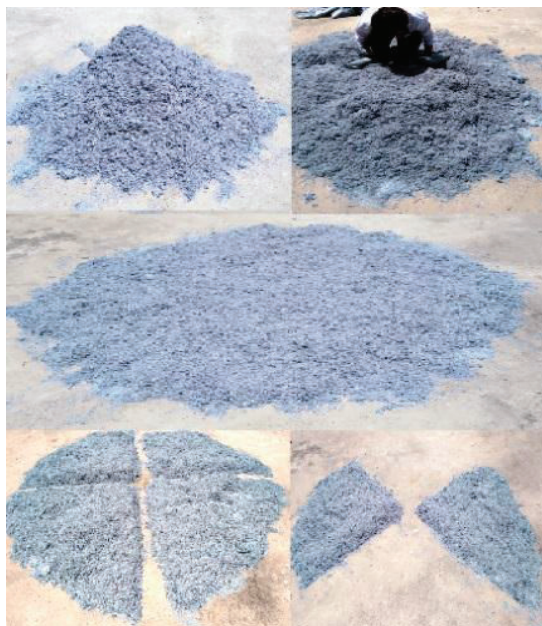
Figura 2.2. Proceso de homogeneización y cuarteo de las VWB
