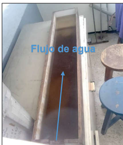
Figura 3.3. Desarenador de flujo horizontal después de 90 segundos de retención
