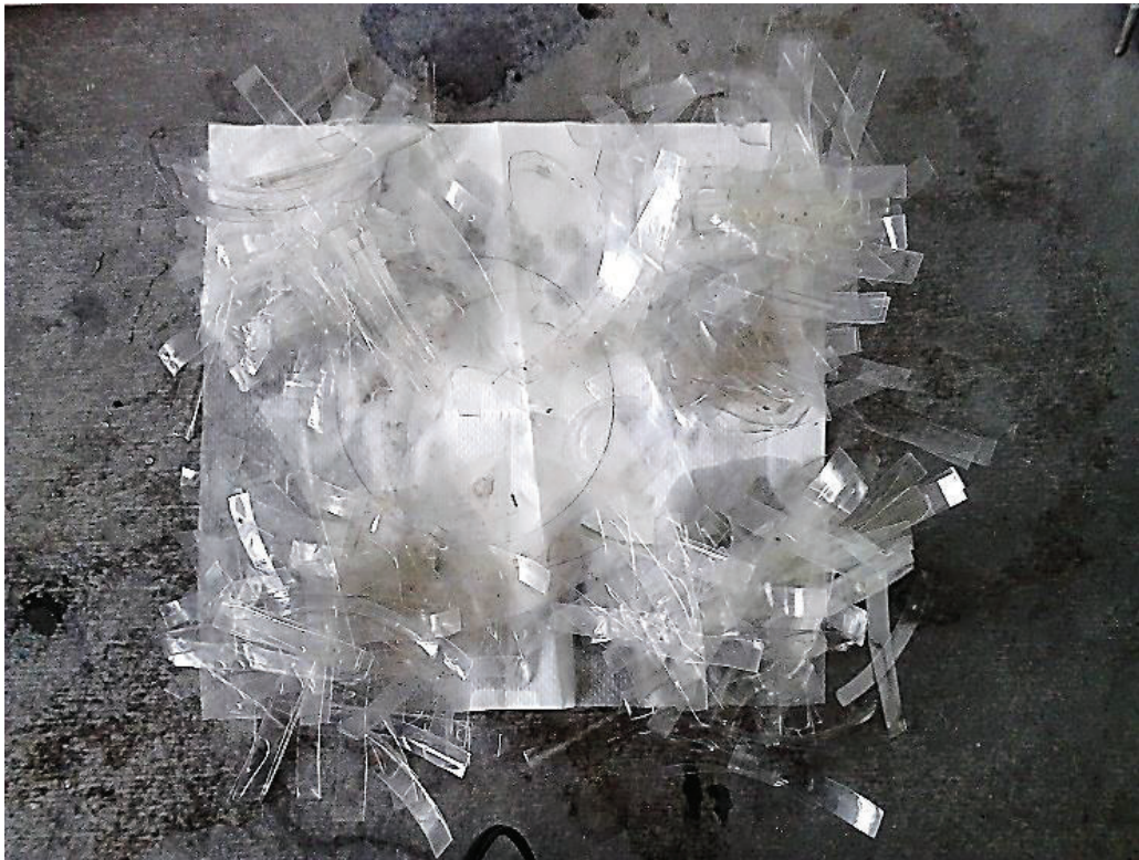
Figura 2.3. Cuarteo para obtener una muestra representativa del lecho estático de PET
