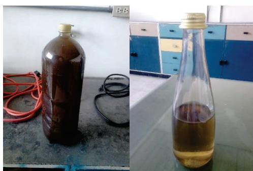
Figura 3.4. Comparativa del agua que entra al desarenador (izquierda) y efluente obtenido desde el desarenador (derecha).
