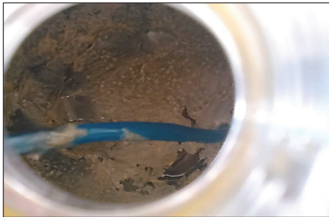
Figura 1.3. Formación de una nata de sólidos suspendidos mediante flotación
