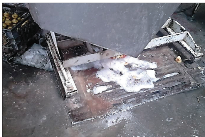
Figura 2.1. Zona de descarga del efluente en la fábrica de frituras donde se determinó el caudal.
